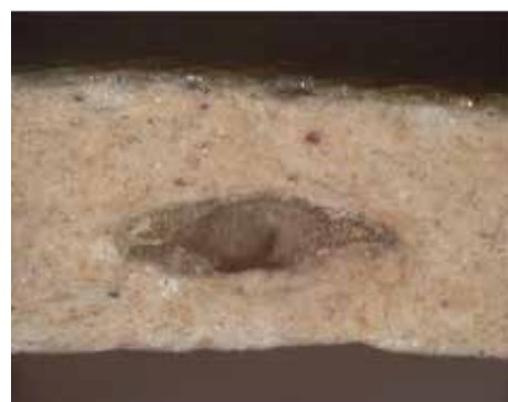
図 3-5-3 No.12 の破面で観察できる密度が高い部分
