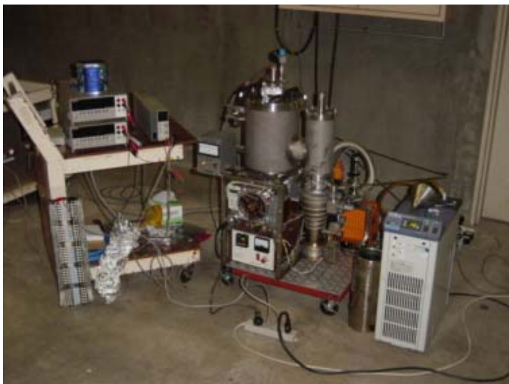
図 14 真空加熱炉
