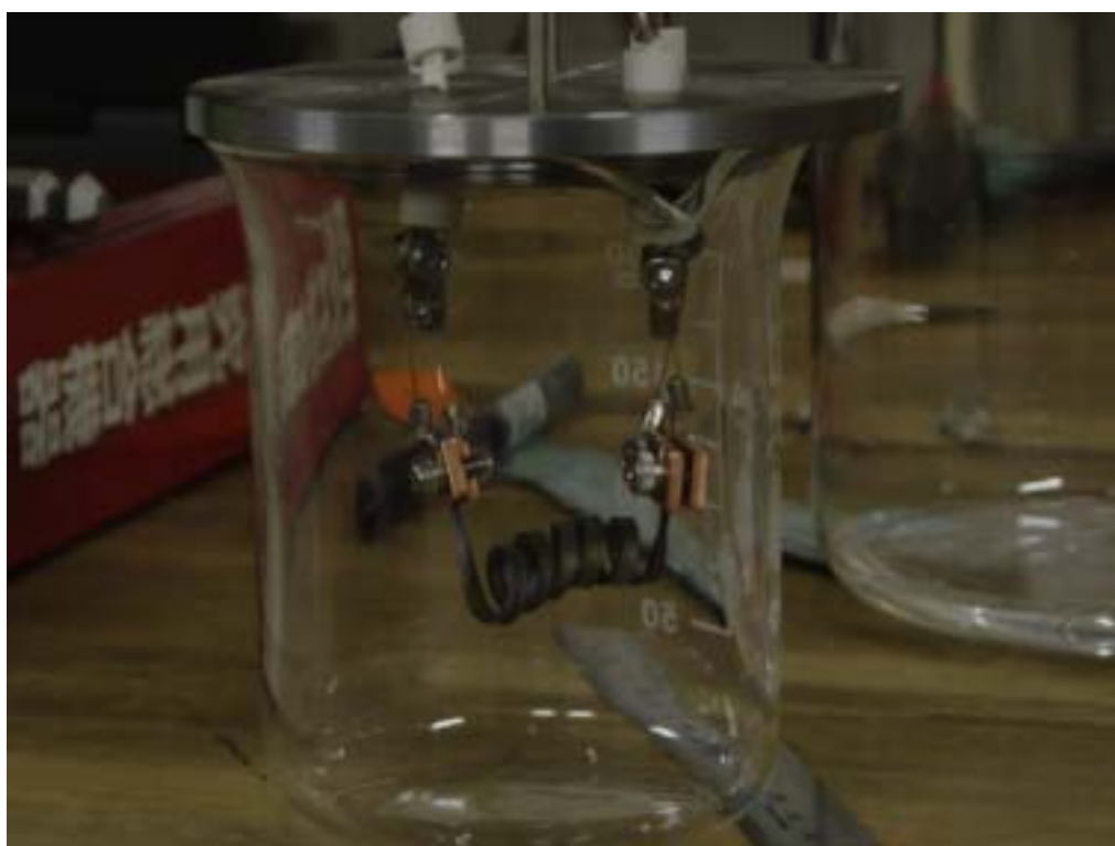
図 15 抵抗率測定用サンプル
