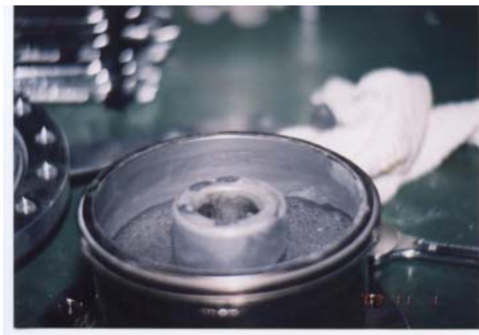
図 25 EBW ビード研磨後
