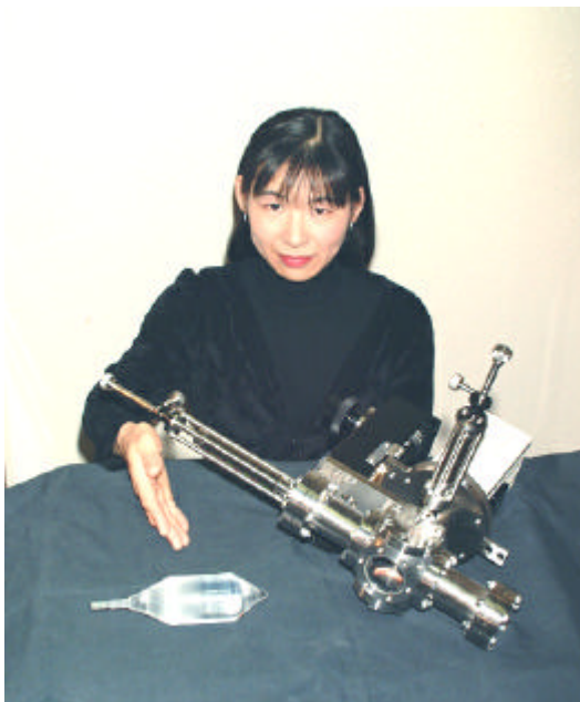
Fig. 5.2.7 LiCAFレンズを用いた真空紫外カメラの全景。
