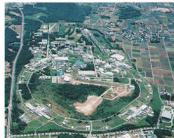
KEKに建設されたBファクトリーの全景。環状に見えている地下に周長3kmのリングがあり、その中で電子と陽電子がたがいに逆向きに回り、一カ所で衝突する。ここで生成されたB中間子と反B中間子のペアが研究の対象である。
