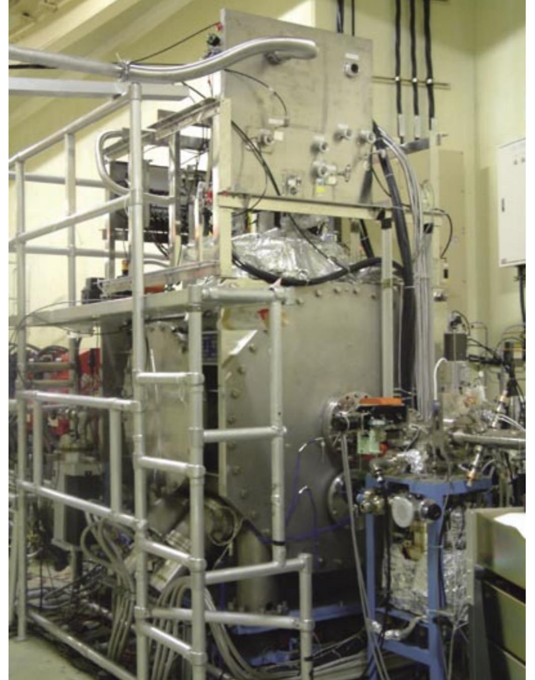
縦型超伝導ウイグラー光源。水平磁場で垂直偏光の硬X線を出す光源としては世界唯一の光源で、液体ヘリウムタンクの中に5T(テスラ)の水平磁場を発生させる電磁石が1対装着されている。これにより、臨界X線エネルギーがほぼ20keVのX線スペクトルが得られる。下の写真は、それを利用した本記事の研究が行われるPFのステーションBL14Bの実験風景。写真の人物は同僚の杉山弘博士。
