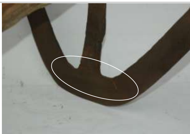
ミカヅキの刃にみられる鍛冶職人による修理の痕跡
