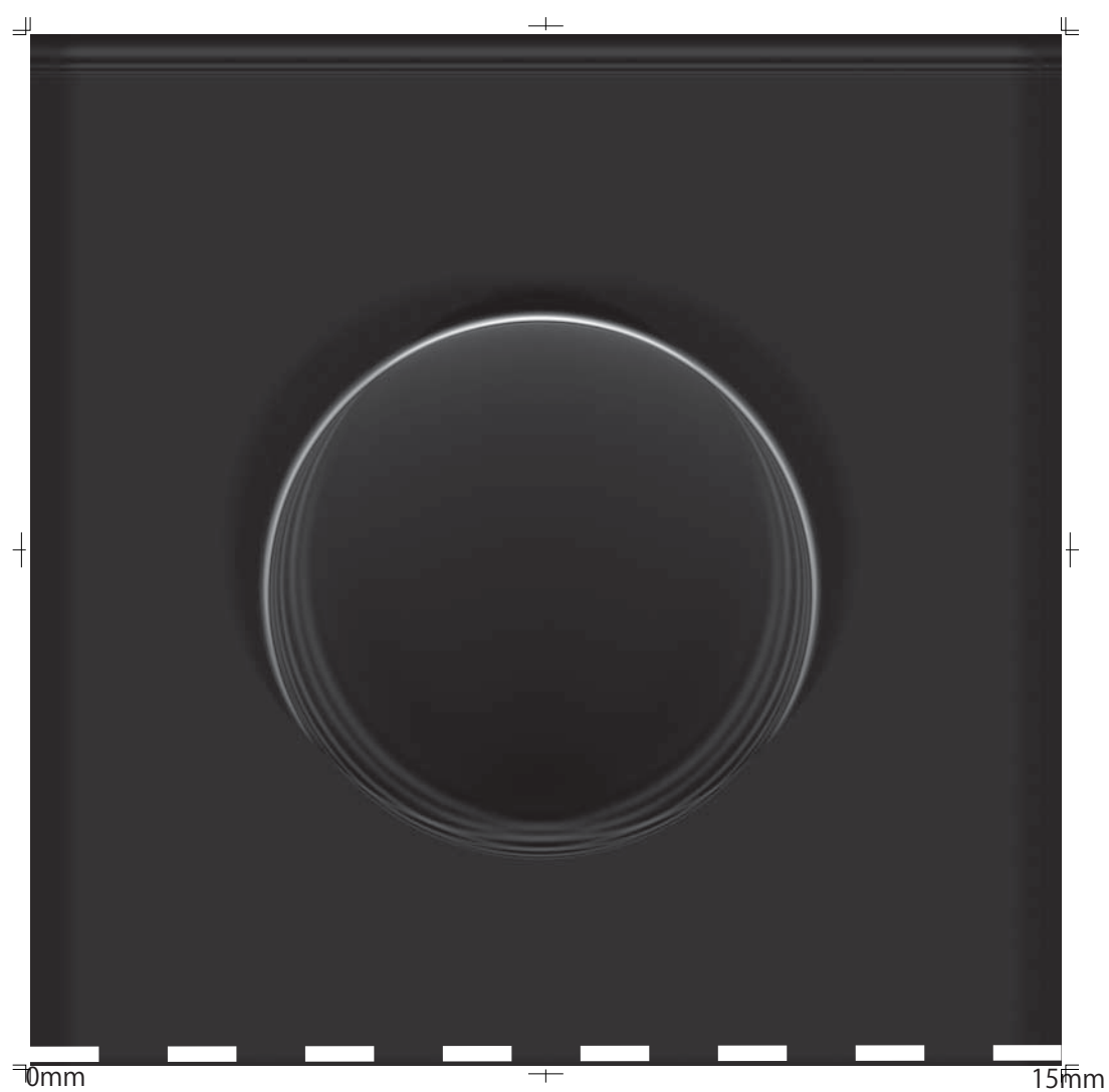
図 7.5 計算機シミュレーションによる三波回折の場合の透過方向の屈折撮影画像
