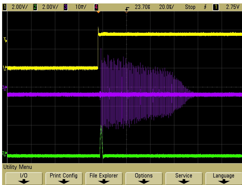
図 75 : RF を切った状態でビーム入射を行い、壁電流モニタ（紫色）で入射ビームを測定した。黄色は入射トリガ、緑色はパルス 6 極電磁石の励起電流。水平方向のスケールは 20 \mu\text{sec}/\text{div} 。
