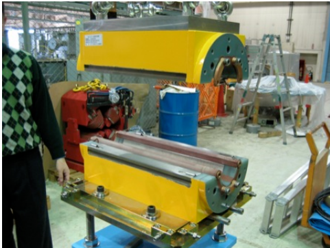
図 54 : 半割にする過程その 3。パルス 6 極電磁石を半割りにしたところ。
