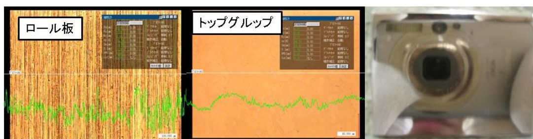
図 8.27 トップグループ前後の銅板表面のレーザー顕微鏡写真とカメラ写真。レーザー顕微鏡の撮影面は幅 270 \mu m、高さ 230mm である。ロール板の表面粗さは R_z=1.42 ，トップグループ研磨面の表面粗さは R_z=0.27 である。
