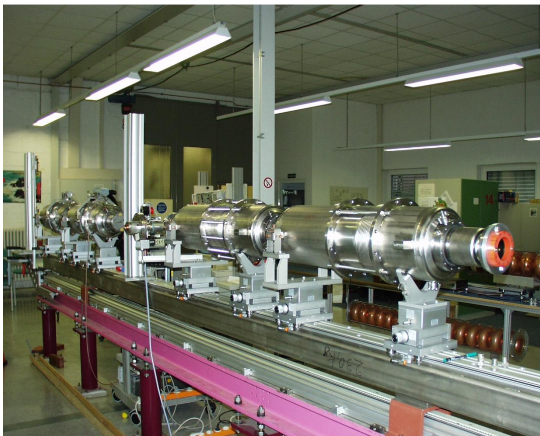
図 12.13 DESY で 7\text{Cell} \times 2 の Super structure. [12.4]
