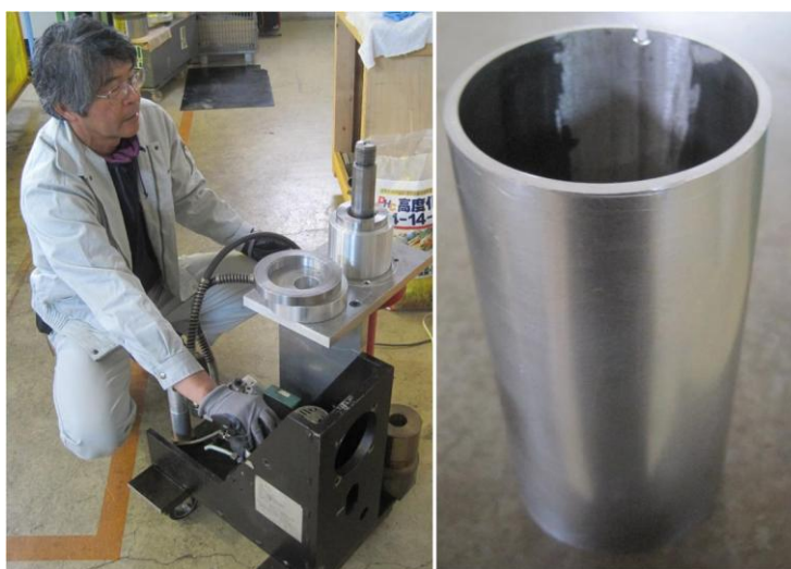
図 8.10 Beampipe を真円に成型している様子と完成した Beampipe
