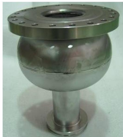
図 8.2 DDC 実証試験のための単 Cell 加速空洞図面と完成した単 Cell 加速空洞
