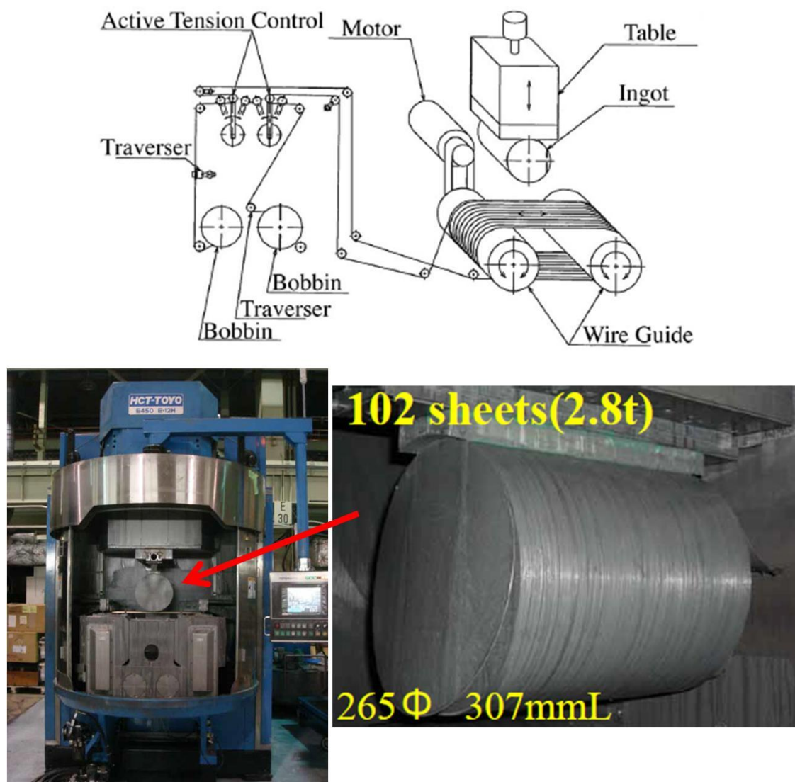
図 8.3 ニオブインゴットのスライス時の模式図と写真。参考文献[8.5]より転載。
