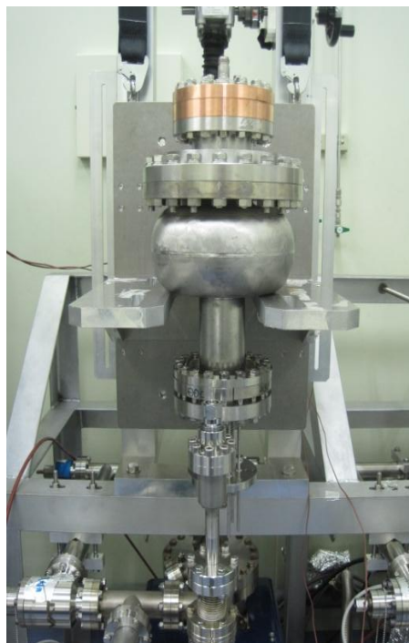
図 9.15 DDC の真空排気の様子。
