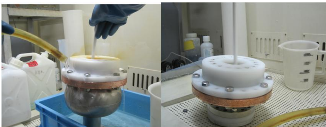
図 9.5 化学研磨の作業風景。ここでは 2 台目の DDC 空洞写真を示した。左が加速空洞、右が Choke である。CP 液が当たるフランジにはポリエチレンを用い、O リングにはテフロン被覆 O リングを用いている。
