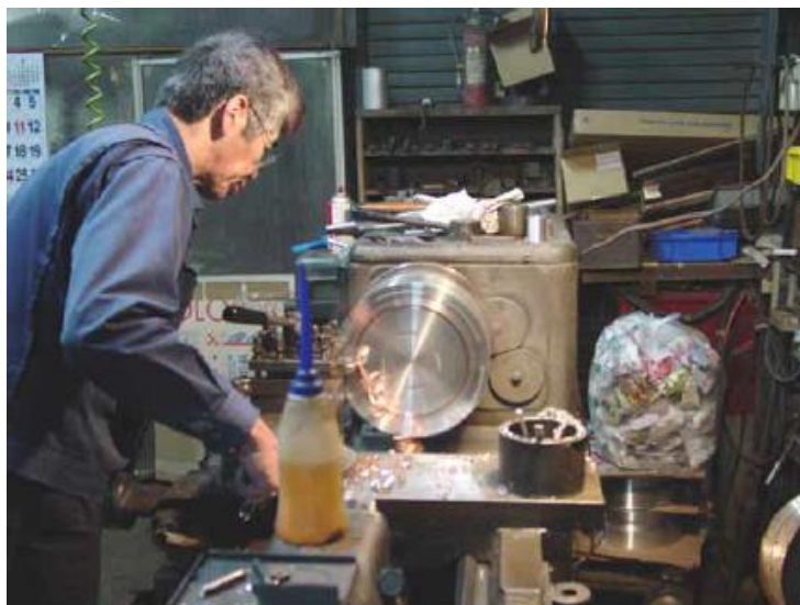
図 8.9 トリム加工の様子。 トリムは石塚製作所で行った。
