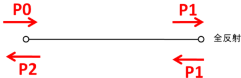
図 10.6 伝送線路中の RF パワー。
