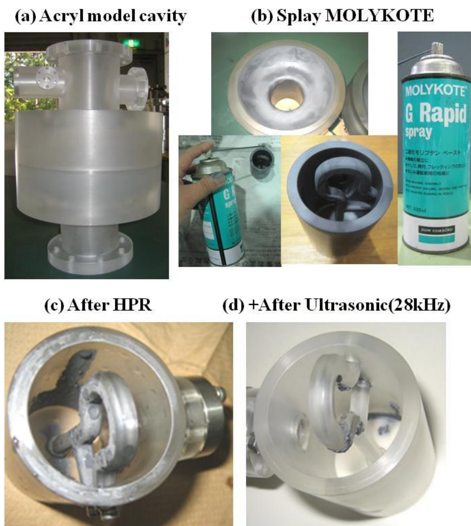
図 2.20 アクリルモデル空洞による洗浄効果の確認実験。参考文献[2.16]より転載。
