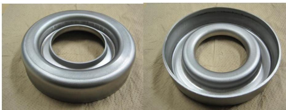
図 8.24 平面部を再度プレスして完成した Choke 部
