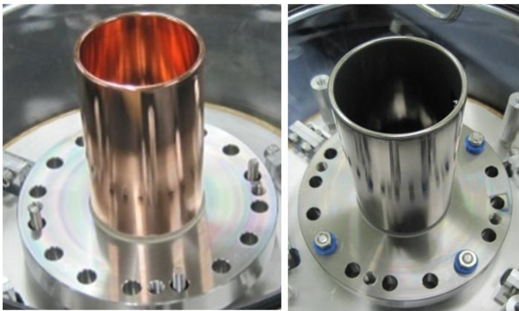
図 8.33 ニオブスパッタ前後のニオブ薄膜内導体。
