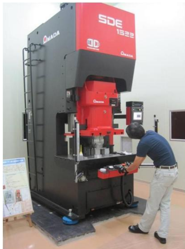
図 8.15 KEK の所有するアマダ社製サーボプレス機。
