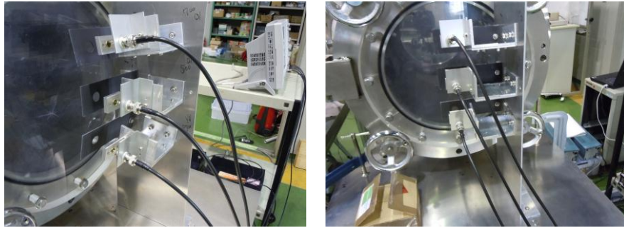
図 2.2.2-1 3波長強度観測用フォトダイオードの配置 (写真)
