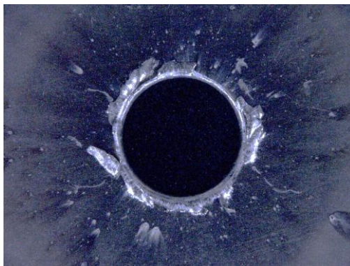
図 3.5.1-1 実験後のターゲットに生じた貫通孔：Agターゲット (厚さ500 \mu m, #26)
