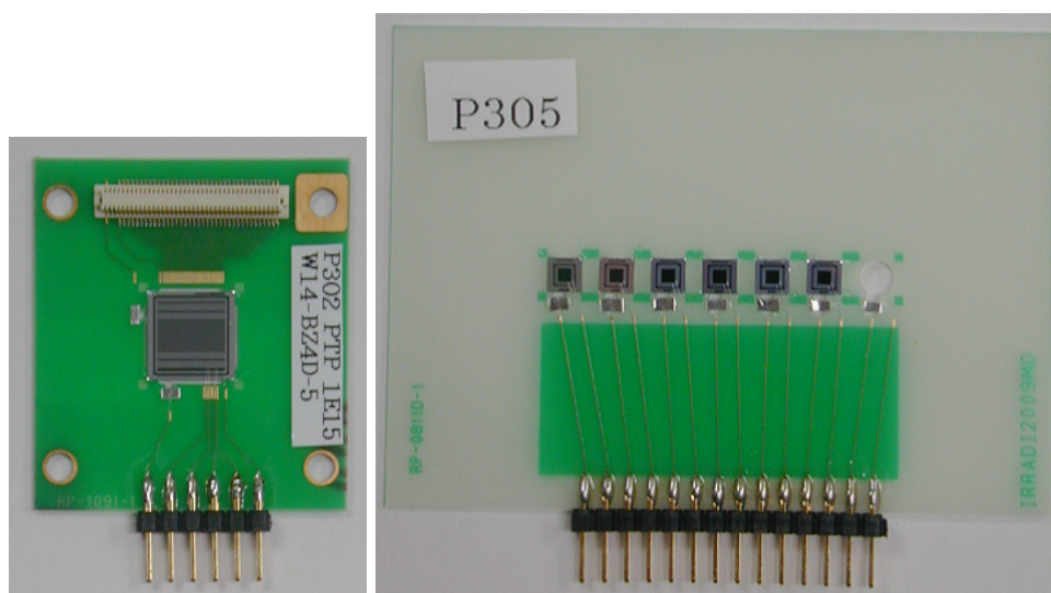
図 2.6: 測定用 PCB ボードに貼りつけたミニチュアセンサー (左) とモニターダイオード (右)
