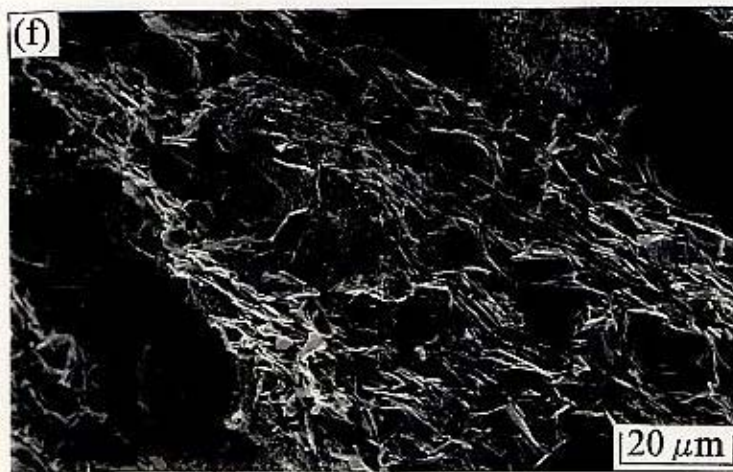
Fig. 3.4.1-1 Continued; (d) ZrO 2 /BPSCCO, (e) SiC/BPSCCO, (f) Si-Ti-C-O/BPSCCO.
