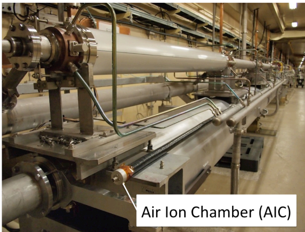
図 3. 1. 2 : Linac に設置された AIC[3-4]。
