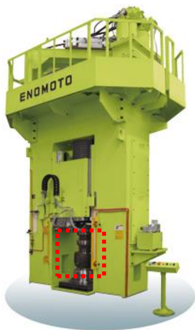
図 2-12 サーボ油圧スクリュープレス機 左: 全体図[2-27]、右: ハンマー周辺(赤枠部)
