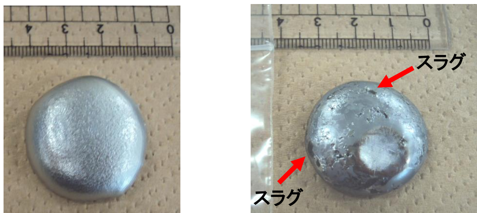
図 2-5 30 g 規模インゴット 左: Y 無添加合金(V-4Cr-4Ti-0.080N)、右: Y 添加合金(V-4Cr-4Ti-Y-0.110)
