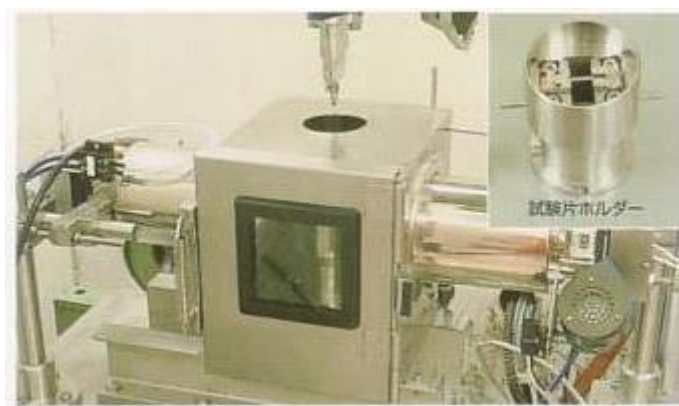
図 2-22 計装化シャルピー衝撃試験機と試験片ホルダーの鳥瞰図
