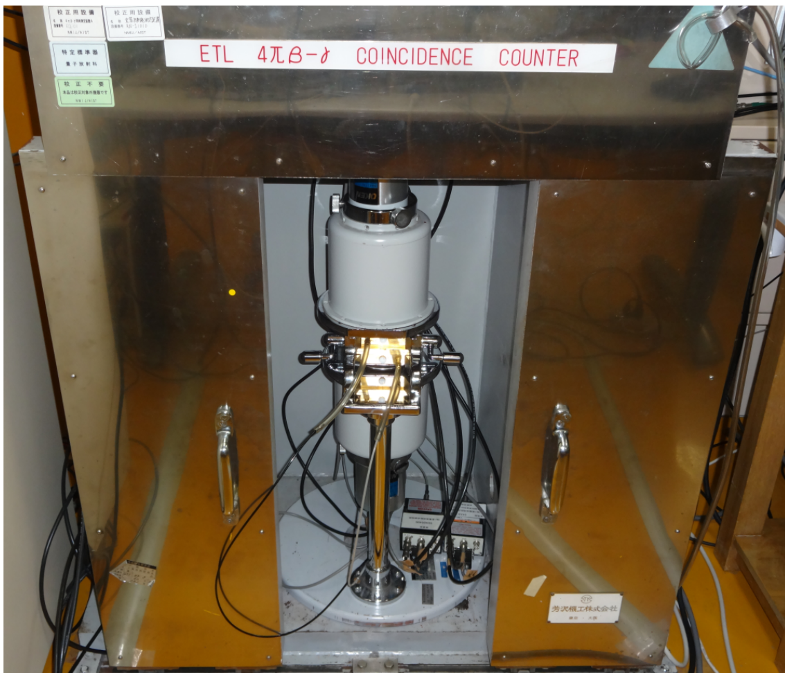
図 2.2 産業技術総合研究所に設置されている 4\pi\beta\text{-}\gamma 同時計数装置
