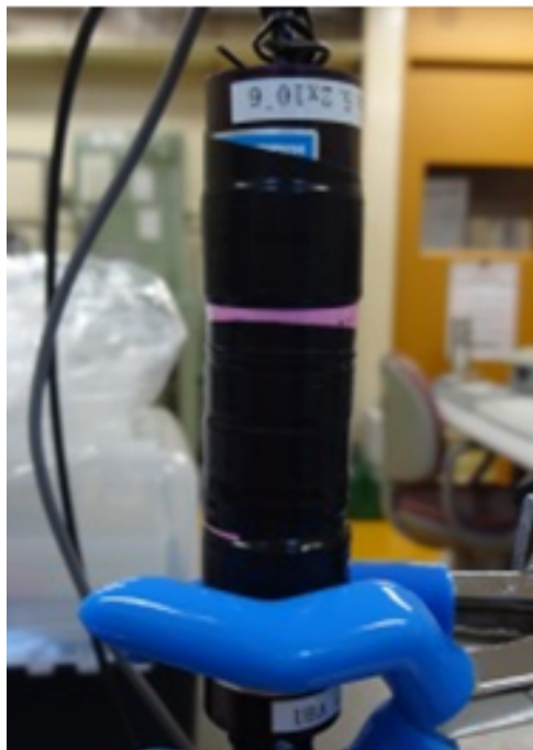
図 4.12 R9880U-210 とプラスチックシンチレータ（上：光電面にプラスチックシンチレータが乗った状態、下：遮光済みで測定準備完了の状態）
