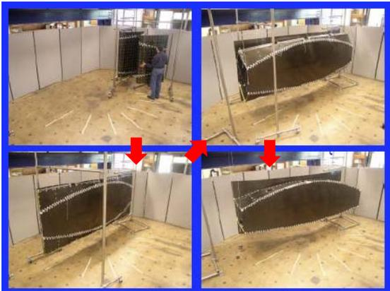
(a) 弾性変形を利用した展開パネル構造[60]
