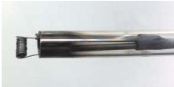
図 2.21: プローブ先端部分の写真。先端チップに電流を導入する2本の線は互いにセラミックとテフロンのチューブにより絶縁されている。さらに、その上からコルツチューブを被せることにより、先端チップを除く部分をプラズマから絶縁している。
