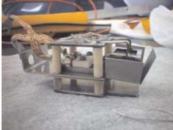
図 2.13: 遮蔽板を取り付けた状態の電子銃ヘッド部分の写真。この写真では、遮蔽板はカソードと電氣的に接続されている。
