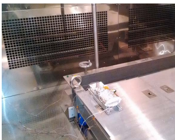
Fig.2-4 大型恒温槽内に設置した SUS OHP 金属製台の上に設置しているのが OHP。熱電対線やヒータの電線は恒温槽外に設置しているローガーに接続している。OHP 奥の格子が大気吹き出し口である。
