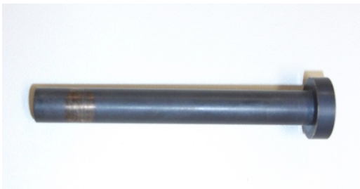
図 2.3.9-3 水素吸蔵により破損したバナジウムセル (水素化した部分が変色)
