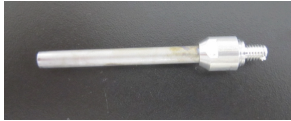
図 2.3.8-1 ex situ 中性子回折測定用セル
