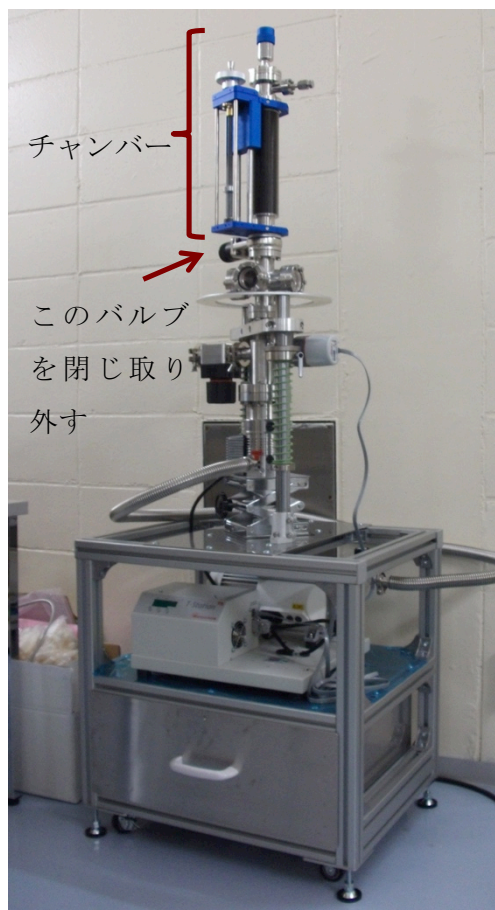
図 2.7-1 Al K-Edge XAFS 測定用 チャンバー
