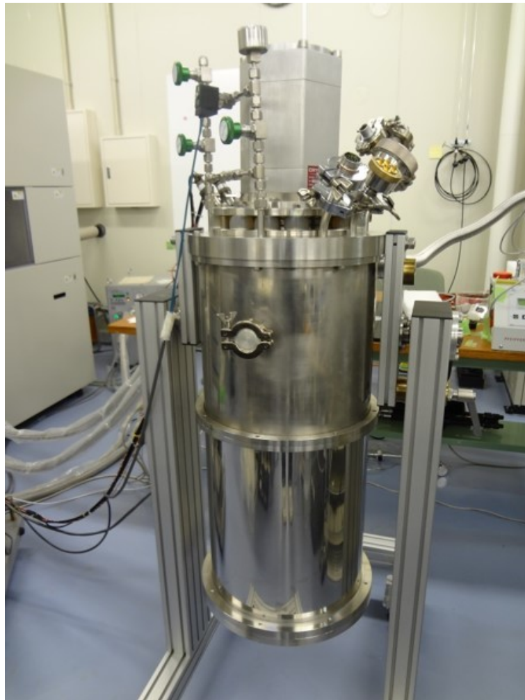
図 5.2: クライオスタットとソーブション冷凍機の外殻
