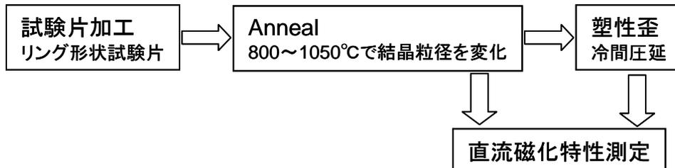
図 2-16 塑性歪による保磁力の変化におよぼす結晶粒径の影響の実験方法
