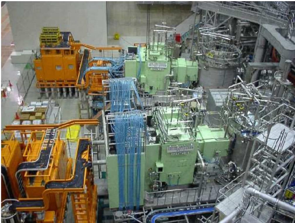
図 1-5 LHD に設置されている中性粒子入射加熱 (NBI) 装置
