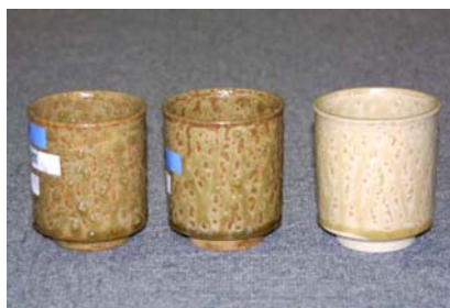
図 3-19 イラボ釉のアワ（左が改善前の赤素地、中央が改善後の赤素地、右は白素地）
