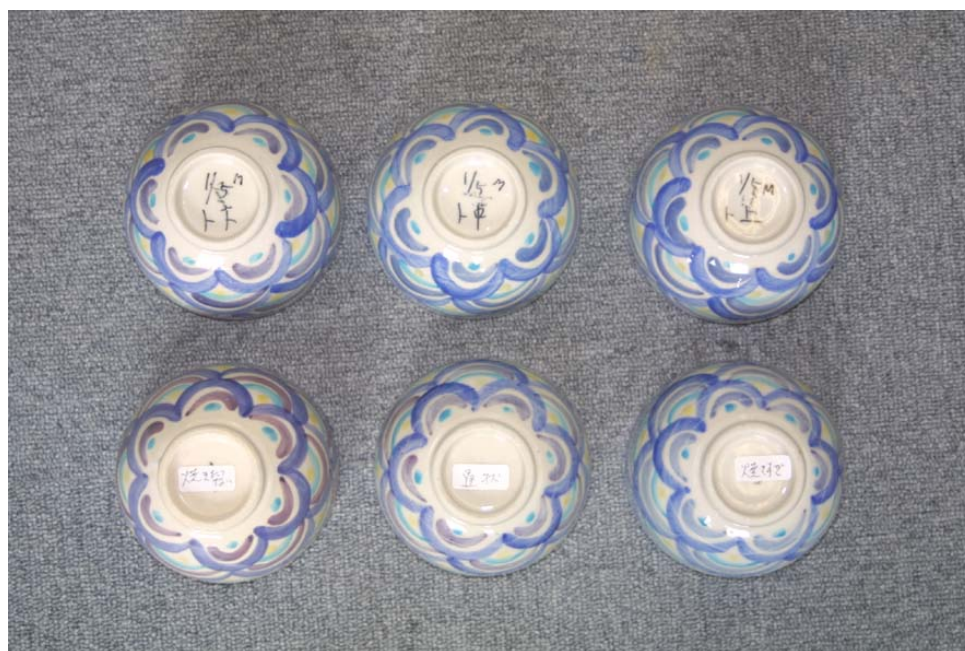
図 4-8 マイクロ波－ガス複合炉とメーカー炉焼成品との比較 上段 マイクロ波－ガス複合炉焼成 下段 メーカー従来ガス炉焼成 (左；最低温度、中；中間温度、右；最高温度)
