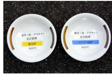
図3-29-4 転写焼成後光沢処理 (左が電気炉焼成、右がマイクロ波焼成)
