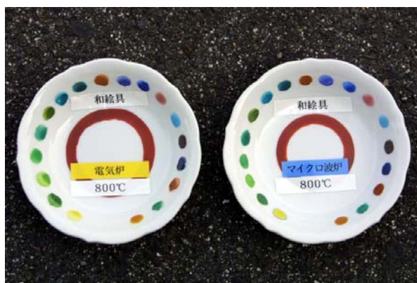
図3-28 和絵具サンプル（左が電気炉焼成、右がマイクロ波焼成）
