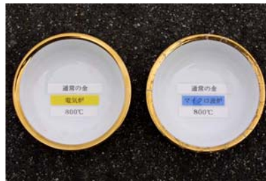
図3-29-5 一般用の金(左が電気炉焼成、右がマイクロ波焼成)
