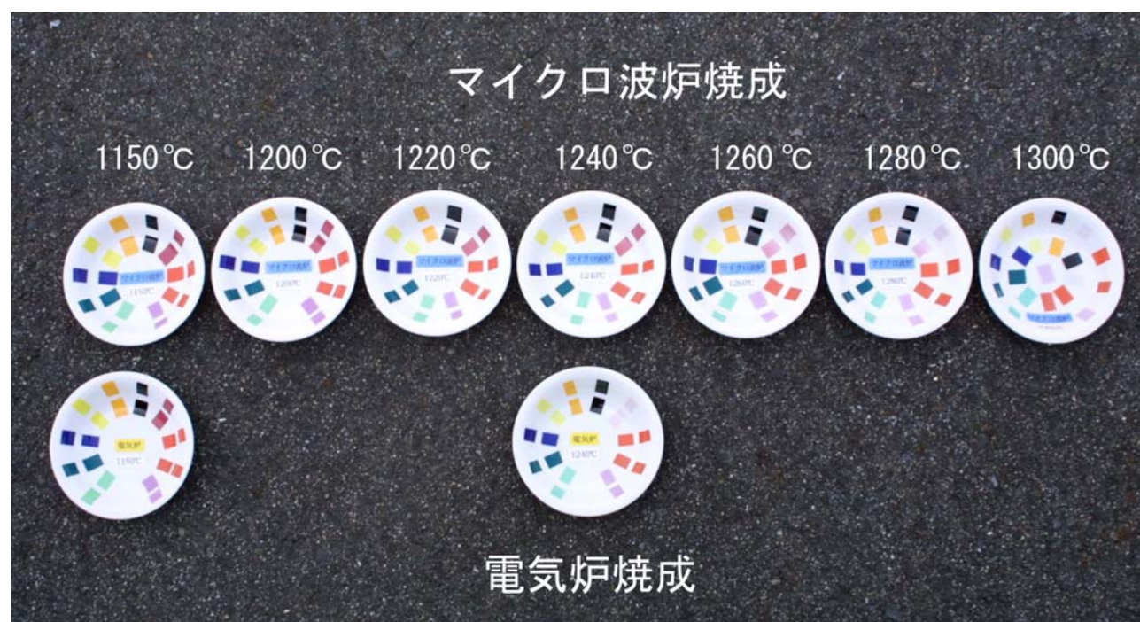
図3-31 イングレーズの10色カラーチャート（上段がマイクロ波焼成、下段が電気炉焼成）
