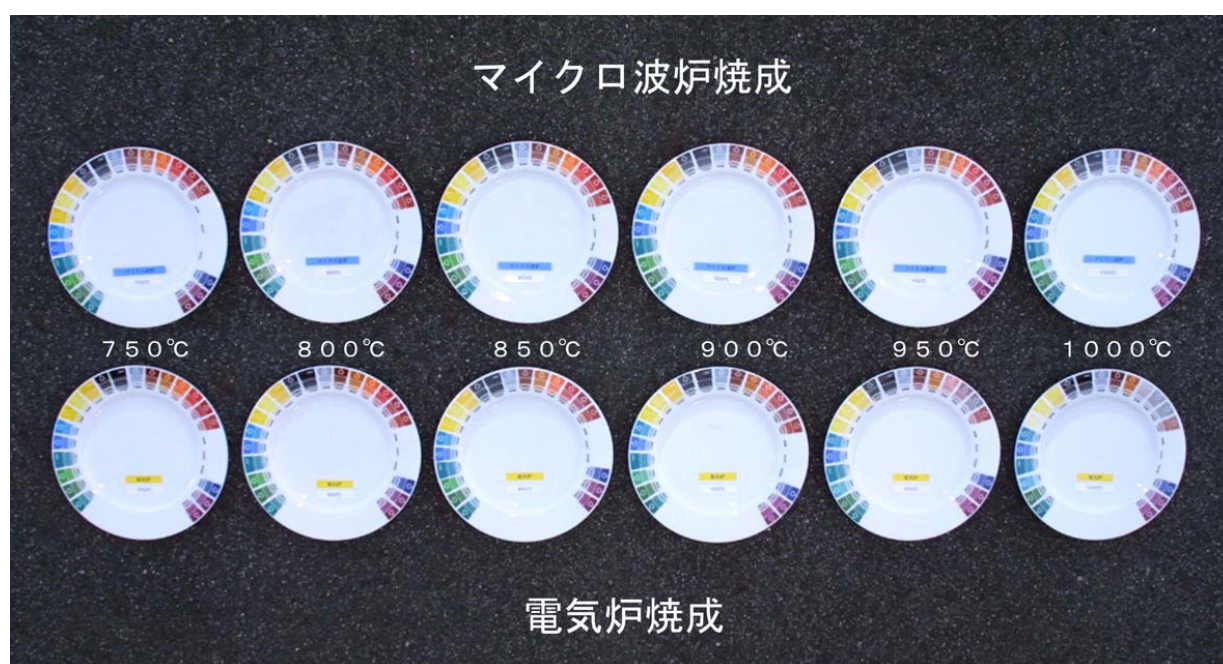
図3-26 サンシャインシリーズのカラーチャート(上段がマイクロ波焼成、下段が電気炉焼成)
