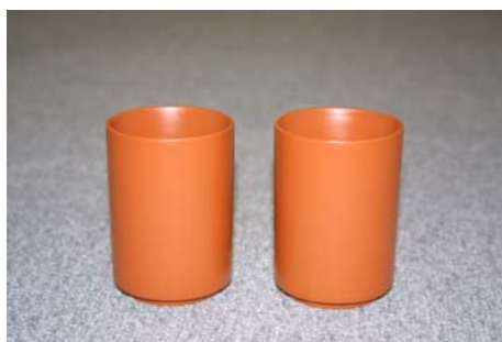
図 4-11 マイクロ波ーガス複合炉焼成品 酸化焰焼成
