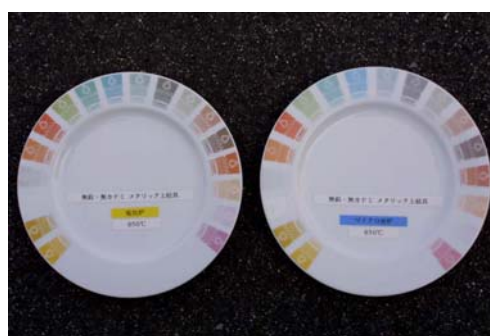
図3-27-2 ファンタジーのカラーチャート (左が電気炉焼成、右がマイクロ波炉焼成)
