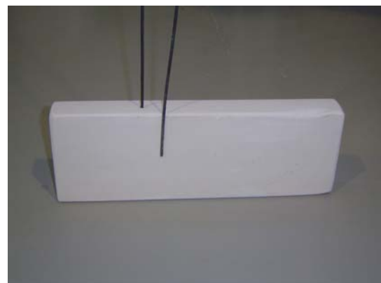
図 5-7 温度測定を行ったブロックと熱電対
