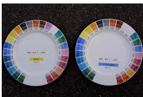
図3-27-1 サンバのカラーチャート (左が電気炉焼成、右がマイクロ波炉焼成)
