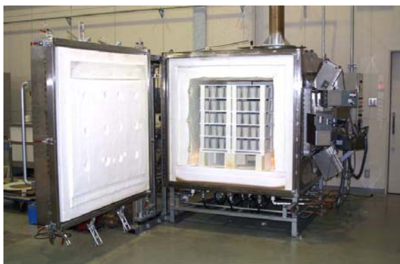
図4-1 マイクロ波ーマイクロ波ガス複合炉
