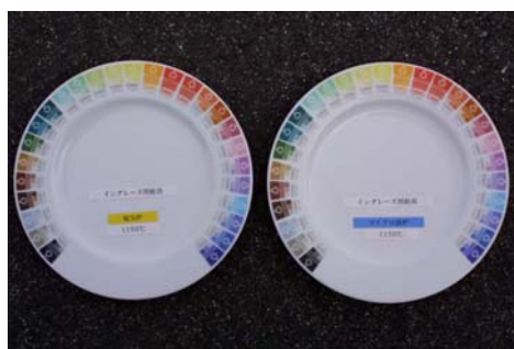
図3-32 イングレースの27色カラーチャート（左が電気炉焼成、右がマイクロ波炉焼成）
