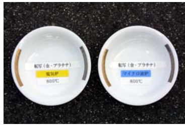
図3-29-3 転写(金・プラチナ) (左が電気炉焼成、右がマイクロ波焼成)
