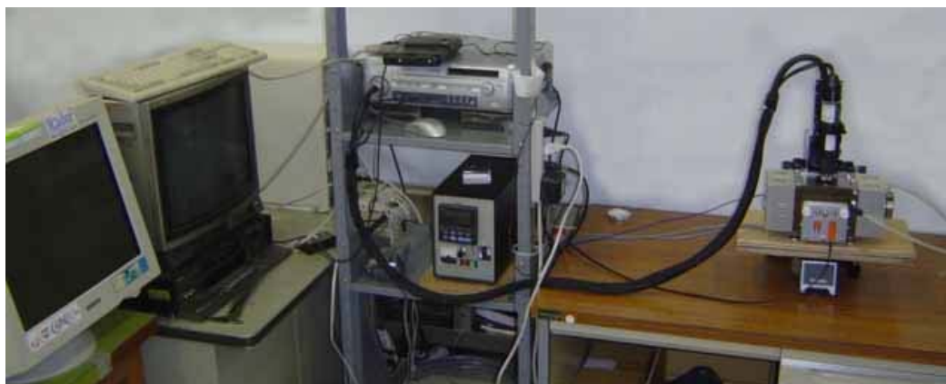
図 2-13 赤外炉と高温型顕微鏡
