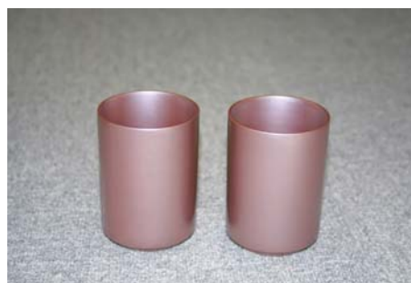
図 4-12 マイクロ波ーガス複合炉焼成品 還元焰焼成
