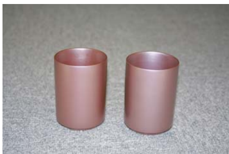
図 4-13 従来ガス炉焼成 還元焰焼成（左；扉下部、右；中心部）
