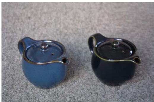
図 4-18 ナマコ釉 （左；従来ガス炉 右；マイクロ波連続炉）
