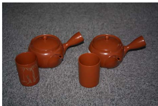
図 4-19 朱泥 （左；マイクロ波連続炉 右；従来ガス炉）
