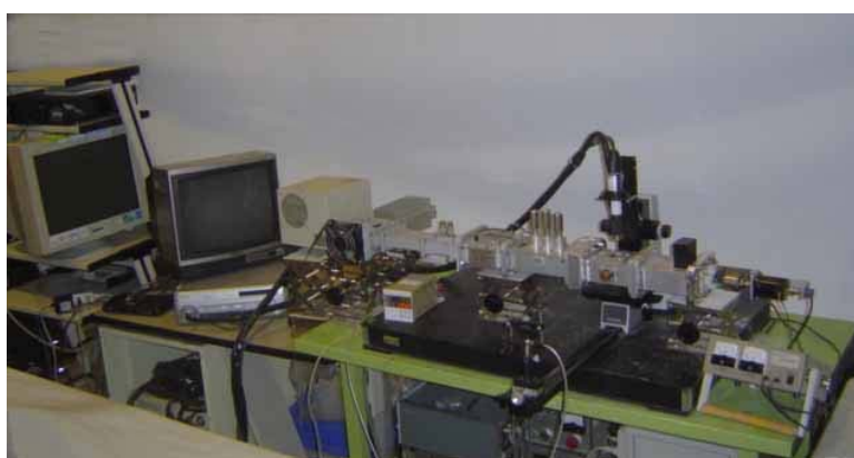
図 2-5 マイクロ波シングルモードキャビティと高温型顕微鏡装置
