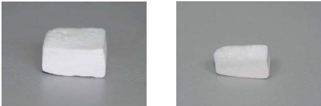
図 2-11 焼成したサンプル（左）とその断面（右）
