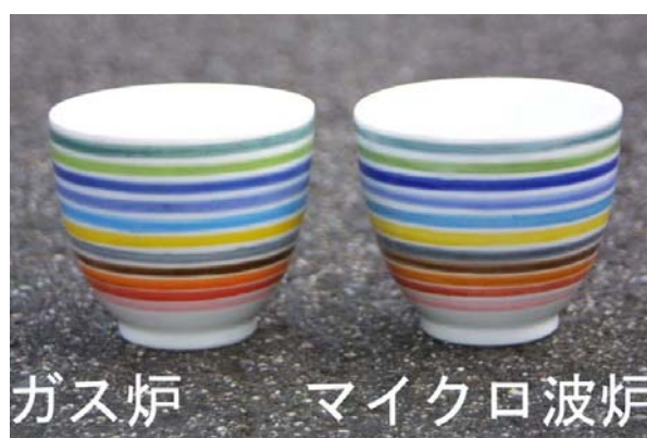
図3-33 下絵のカラーチャート（左がガス炉焼成、右がマイクロ波炉焼成）
