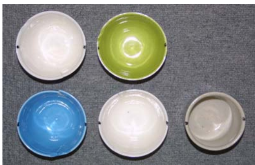
図 4-20 進行方向に歪んだサンプル (写真横方向が進行方向)
