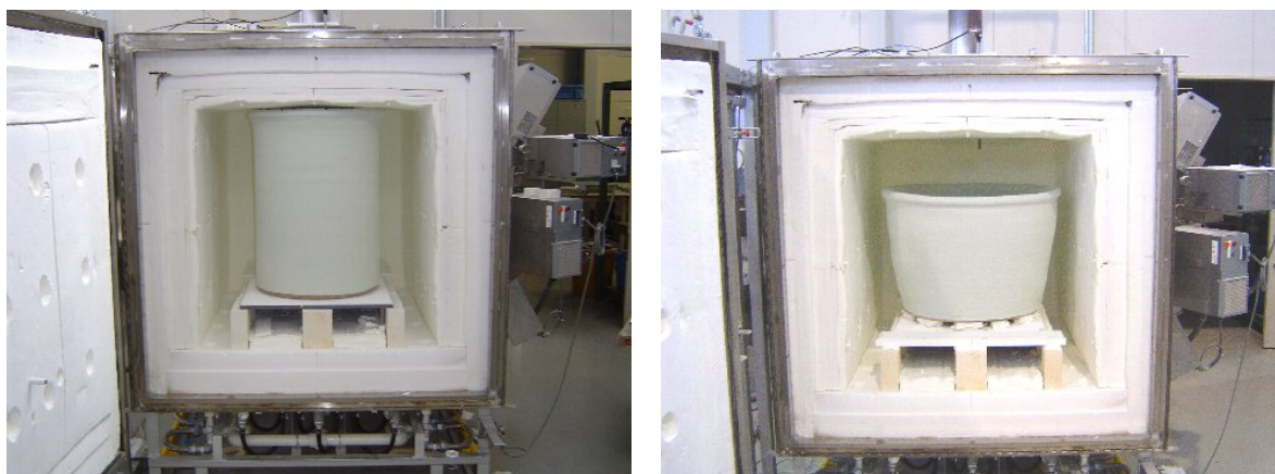
図 5-11 掛け湯壺（左）と風呂桶（右）の窯詰め状況
