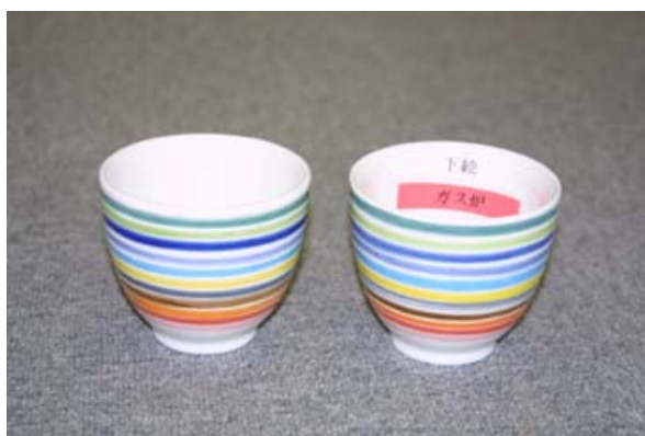
図4-9 下絵の評価結果(左；マイクロ波ーガス複合炉焼成、右；従来ガス炉焼成、)
