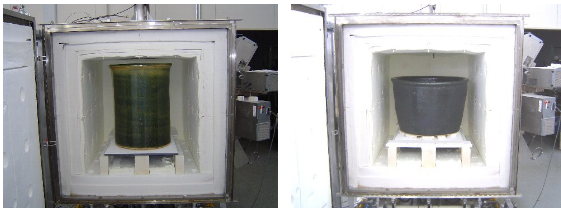
図 5-21 掛け湯壺（左）と風呂桶（右）の焼成後の炉の状況
