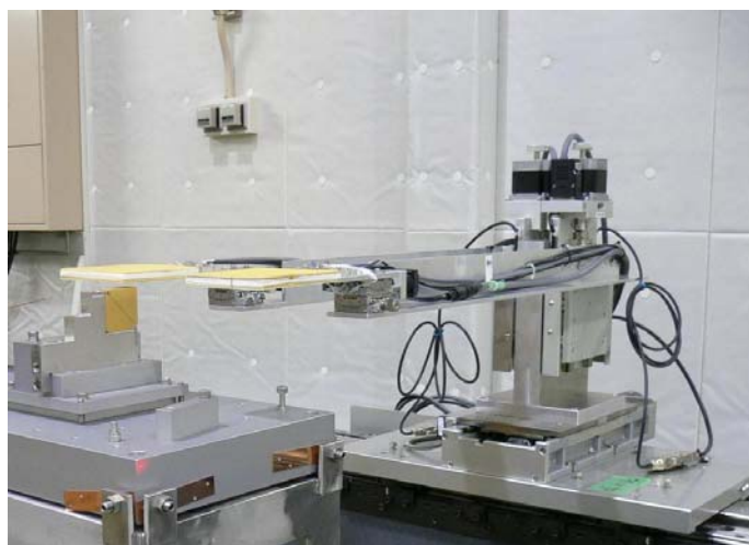
図 5-5 単体磁石ブロックの磁場分布測定の設定アップ
