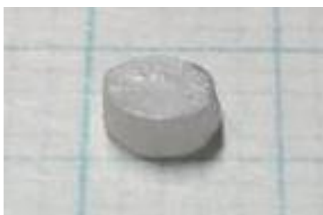
図 4.1 : 新しく製作した HfO 2 ナノ粒子添加プラスチックシンチレータ (HfO 2 添加量 10wt%、φ 3 mm × 1 mm) の写真。
