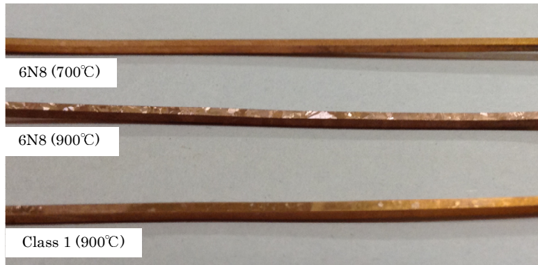
図 2-7 900°Cでアニール処理した 6N8 銅試料と他の試料との比較.
