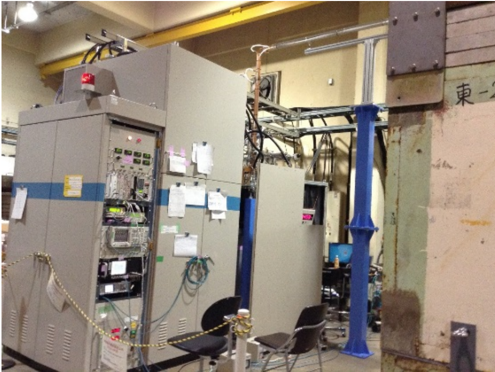
図 4-3 クライストロンとその電源.
