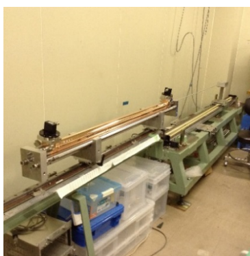
図 3-12 低電力測定治具に設置後の加速管。
