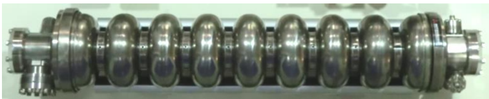
(a) 9セル超伝導空洞単体
