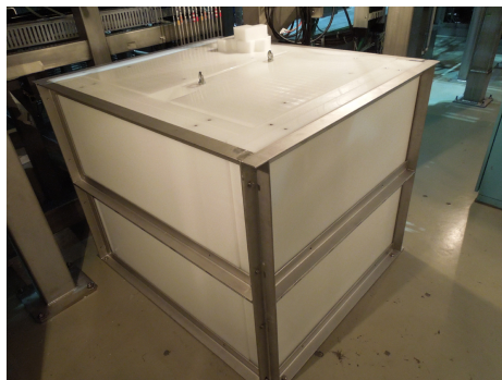
図 8.37: アンプボックスを設置したポリエチレンブロック。
