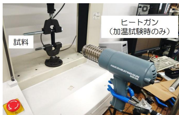
図 2.13 引張試験の様子
