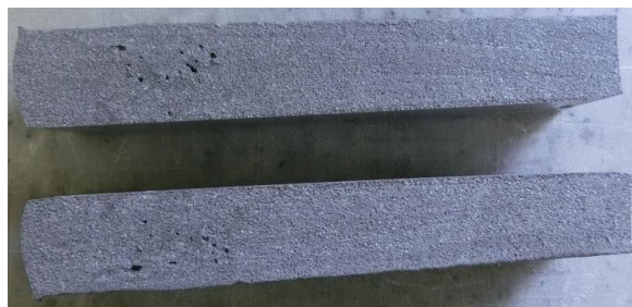
図 5.4 捏和時間 30 分の推進薬断面
