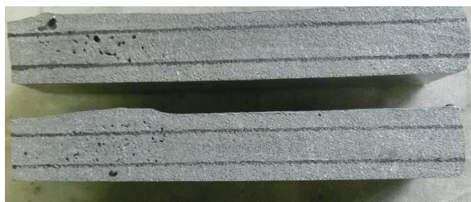
図 4.12 仕込み量 500 g の推進薬断面
