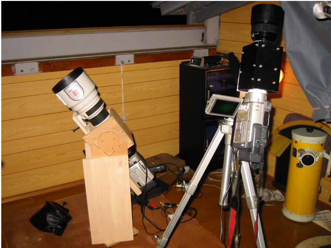
図 2-1 観測機材の外観（観測地:2） 左が 200mm F1.8 のシステム（ビデオカメラ E） 右が 85mm F1.2 のシステム（ビデオカメラ D）
