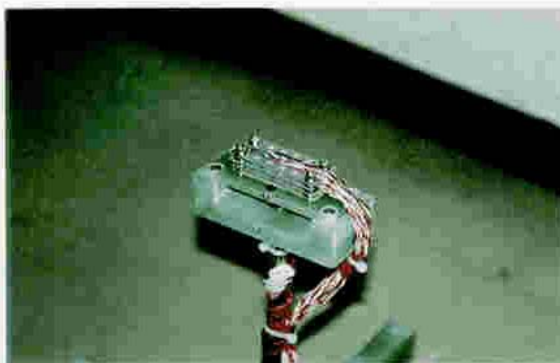
図 4.6 磁場分布観測用ホール素子校正セットアップ
