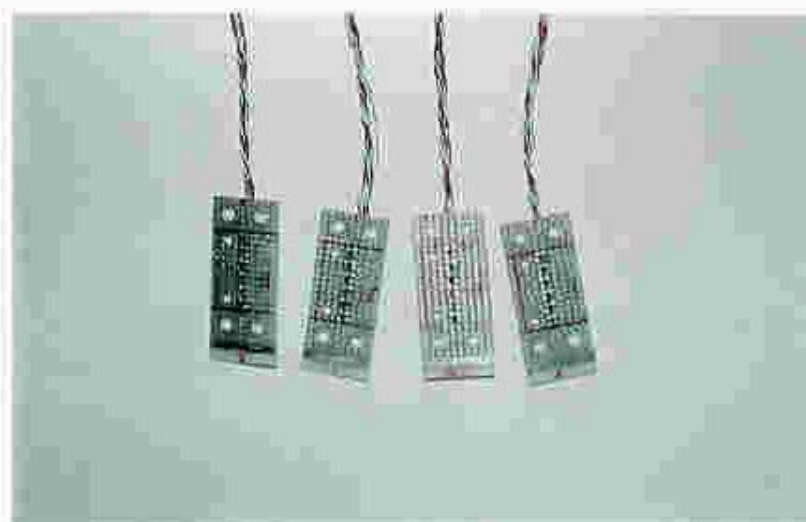
図4.4 磁場分布観測用ホール素子をプリント基板に取付けたところ
