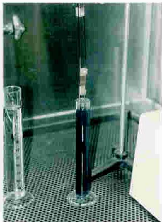
図3.6 超伝導線の安定化材を除去しているところ
