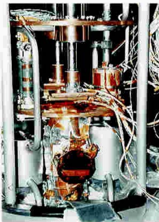
図 A3.9 マグネットに組込まれ、4 Kステージ上に取付けられた永久電流スイッチ
