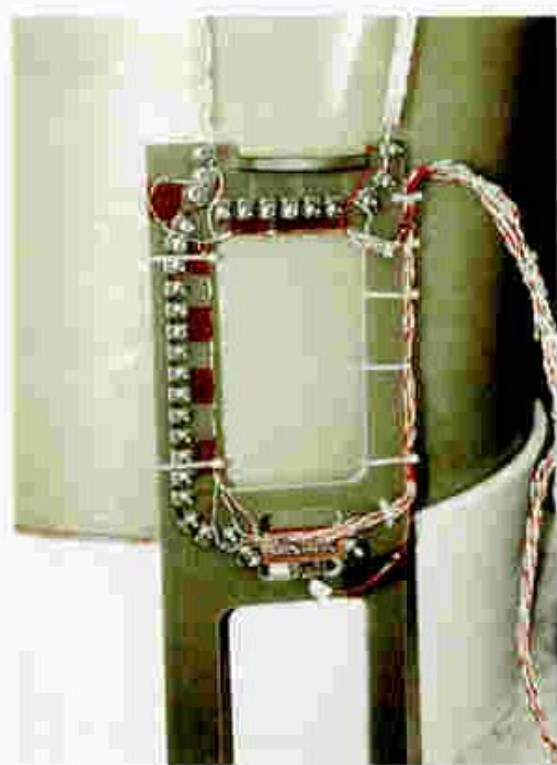
図 5.4 ヘアピン・ジョイントサンプルをサンプルホルダーに取付けたところ
