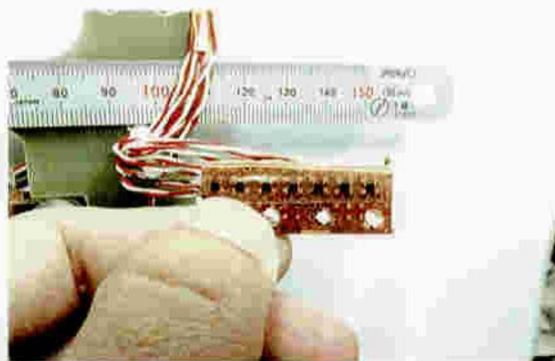
図 5.5 プリント基板に取付けられた磁場分布観測用ホール素子
