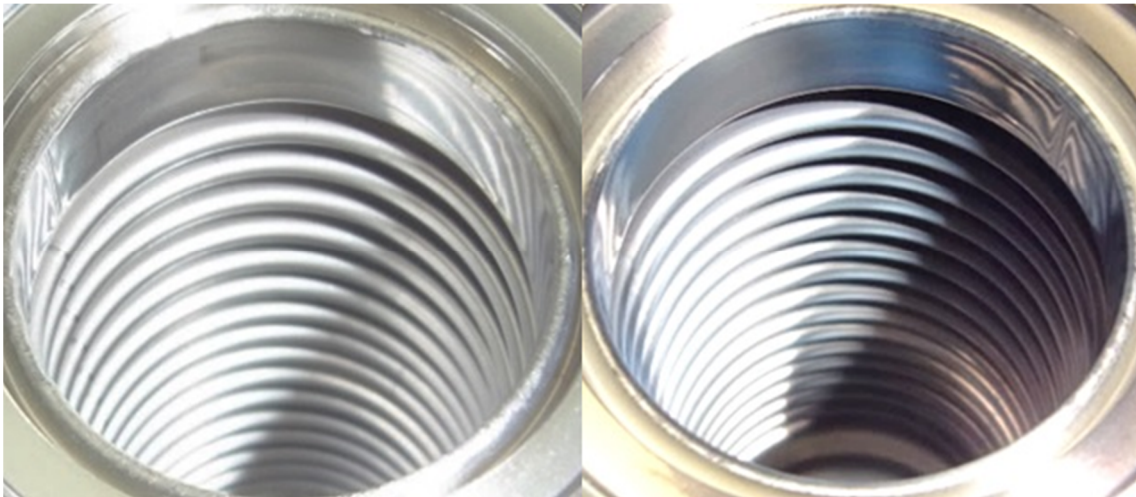
図 5-4 無酸素 Pd/Ti コーティング前と後の成形ベローズの写真. 左側はコーティング前, 右側はコーティング後である.
