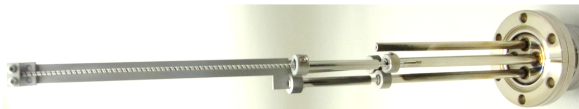
図 3-3 無酸素 Pd/Ti 蒸着源を Ti フィラメント側から見た写真.
