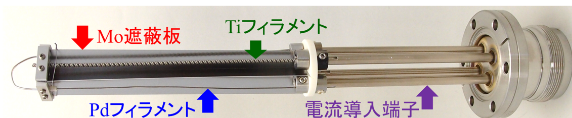
図 3-4 中空回転導入を用いない無酸素 Pd/Ti 蒸着源の写真. Ti フィラメント, Pd フィラメント, Mo 遮蔽板から構成されている.
