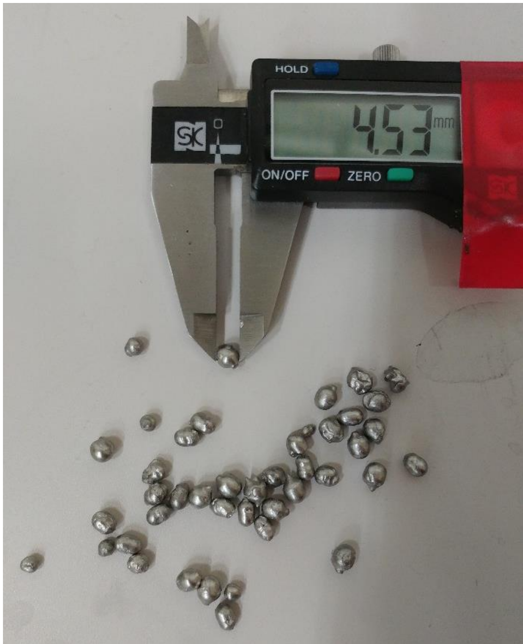
図 3-1-6 製造した直径約 5 mm の U-alloy78 ペブル。
