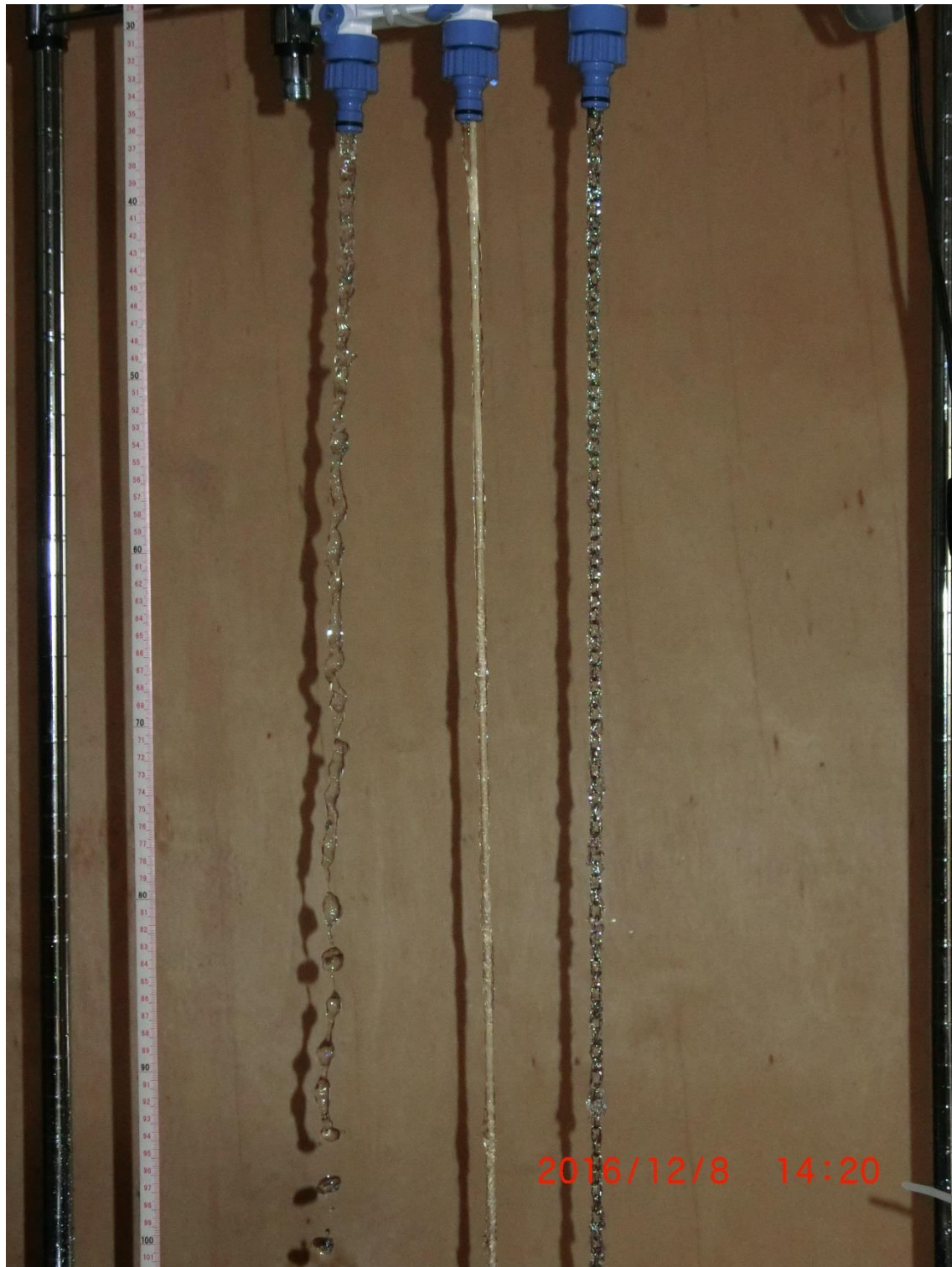
図 2-1 噴流(左)、木の棒入り鞘状噴流(中央)、鉄の鎖入り鞘状噴流(右)の写真(Ref[2-6], Fig.2より引用)。
