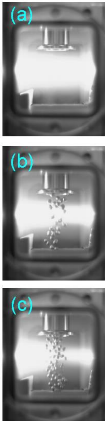
図3-2-4 側面ポートから高速度カメラで撮影した TPDsheet-U シートプラズマの写真 (撮影速度 1/1,000 秒)。(a)はペブル流の無い状態。(b)は直径 4.5 mm の U-alloy78 ペブルを流している状態。(c)は直径 3 mm の U-alloy78 ペブルを流している状態である。
