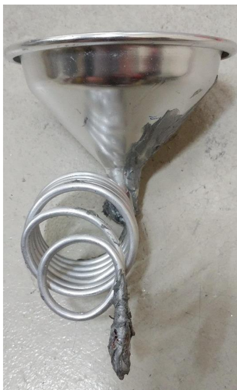
図 3-1-4 実験装置の液体金属導入部分。写真下部のノズル先端をバスボンドで加工している。
