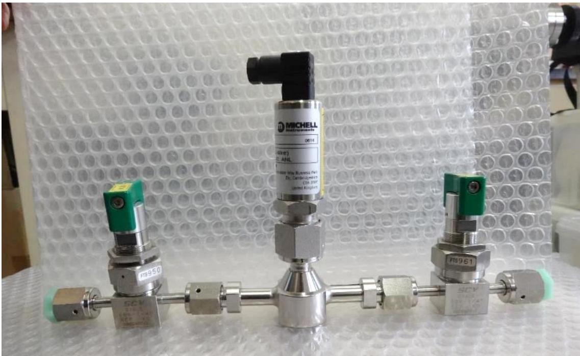
図 3.11 露点計 (PURA 高純度ガス用微量水分トランスミッター, MICHELL)の写真
