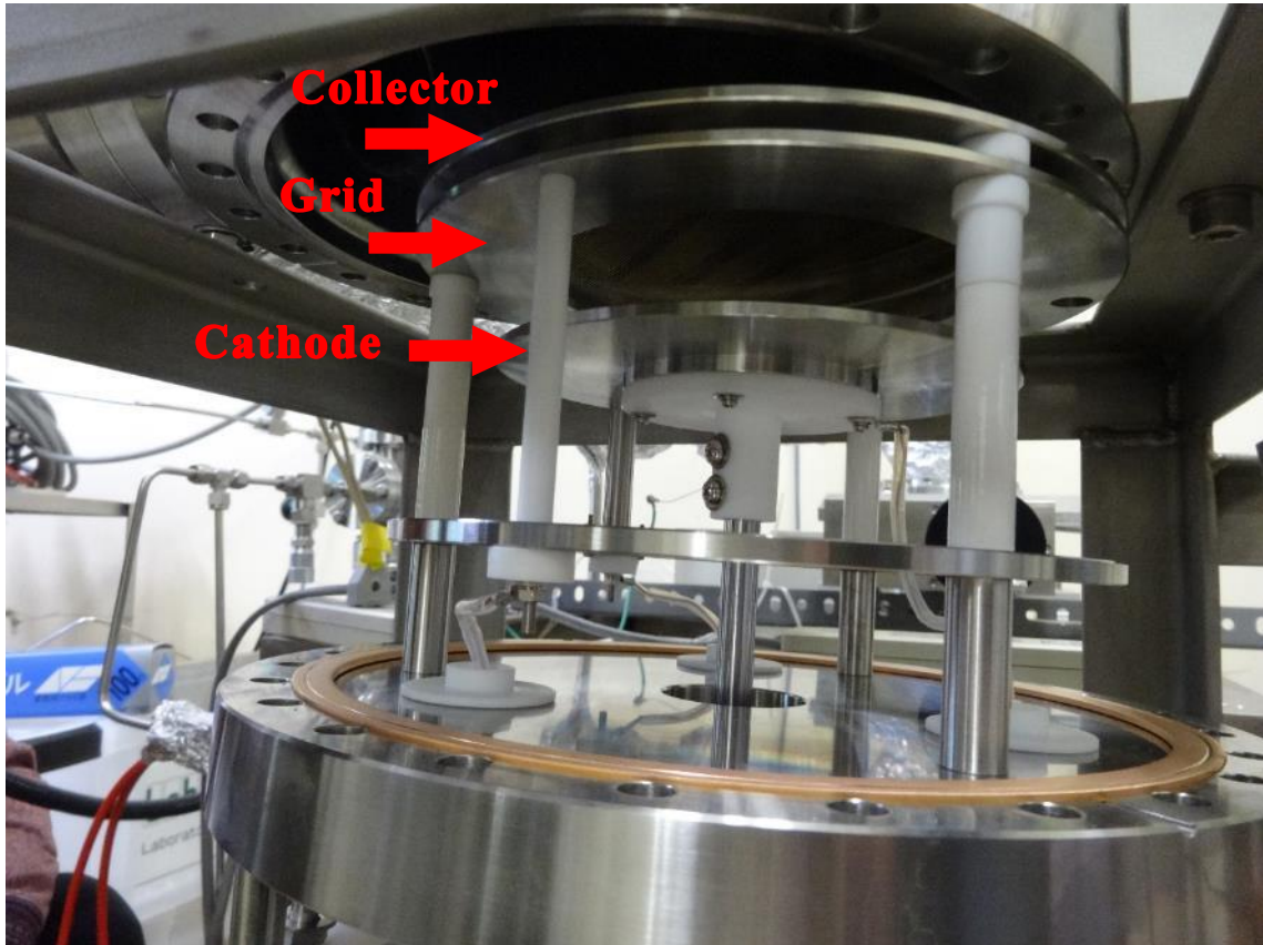
図 3.16 電離電子・シンチレーション同時測定実験装置内部のグリッド型電離箱の写真
