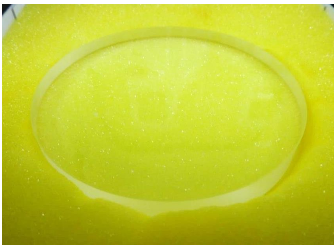
図 4.3 MgF 2 結晶 直径 8.0 cm×厚さ 1.0 cm (応用光研工業株式会社製)
