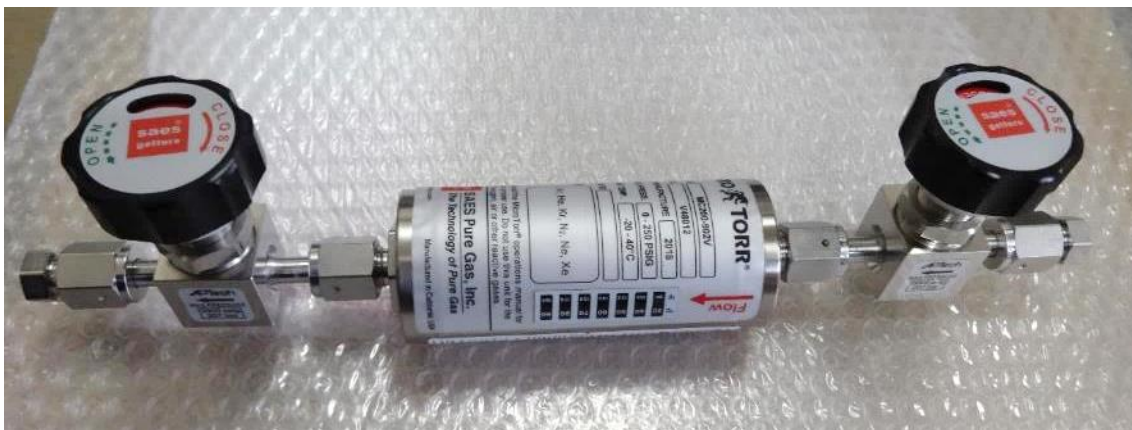
図 3.8 ガス精製器 (MC200-902V, SAES Pure Gas)の写真
