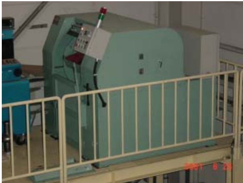
図 3-20. L バンド空洞用遠心バレル研磨装置
