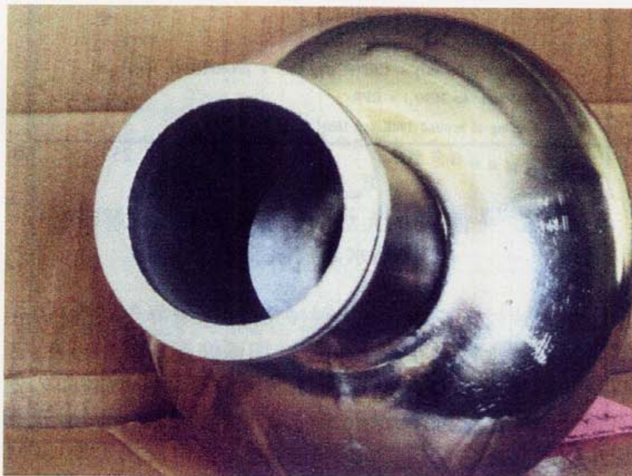
図 7-5. 硝酸 1500ppm で 50 \mu m 電解研磨した空洞内面
