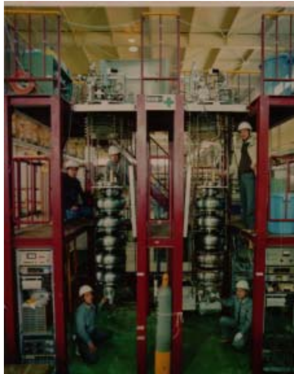
図 1-1 . TRISTAN 508MHz 5 連ニオブ超伝導空洞
