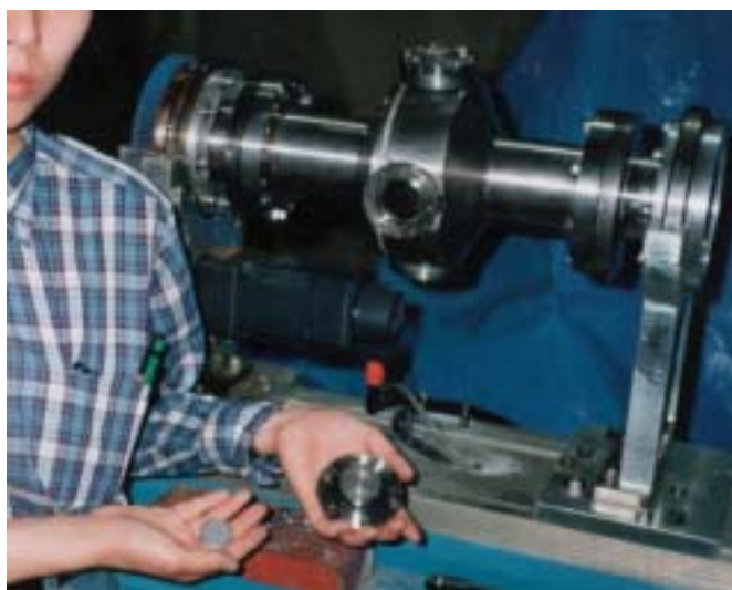
図 2-2 . ステンレス製 L-バンドモデル空洞とこれに取付けるニオブサンプル
