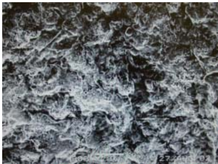
図 8-5. 水素フリー遠心バレル研磨 1 \mu\text{m} 電解研磨面の SEM 像
