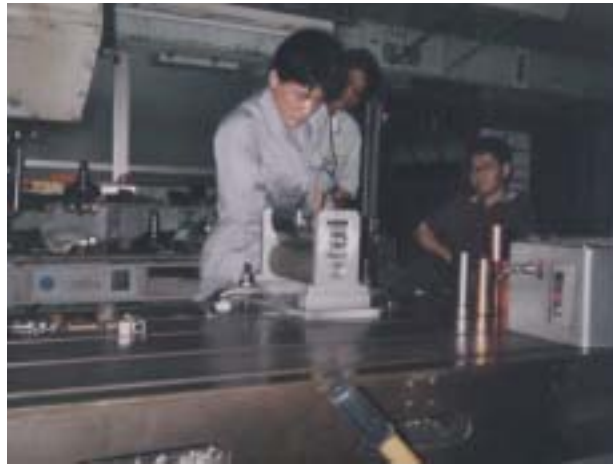
図 3 ビームパイプロール加工 ( プレス機 K E K )
