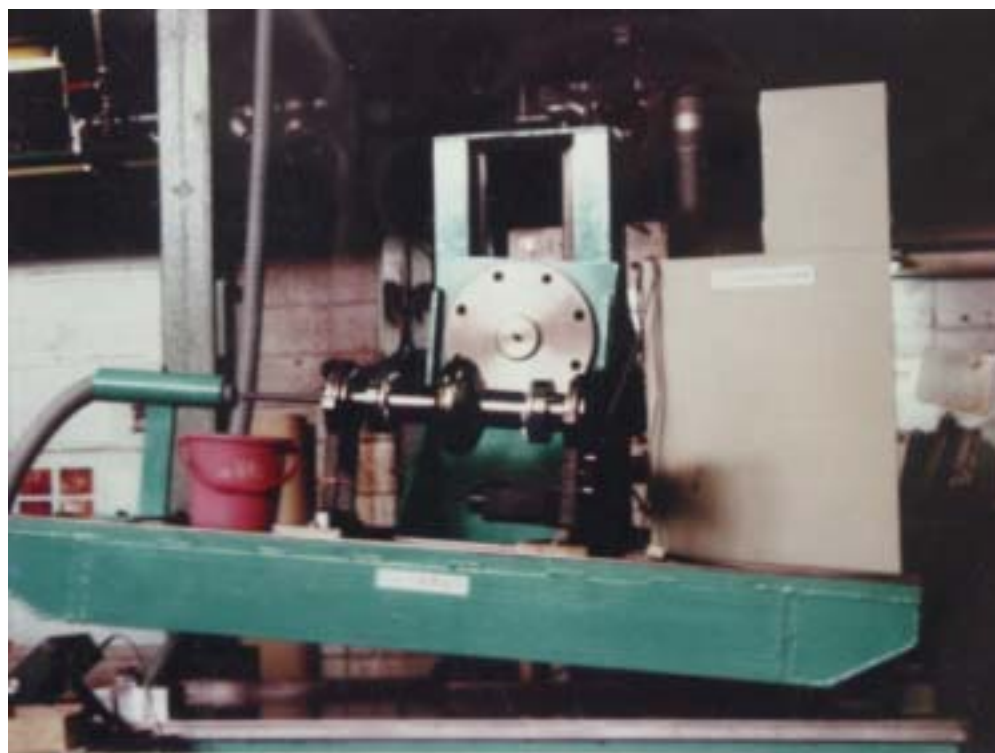
図 3-5 . 化学バレル複合研磨法
