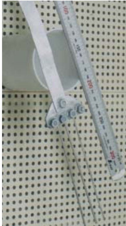
図 5-6. アルミ治具に取付けた ニオブサンプル
