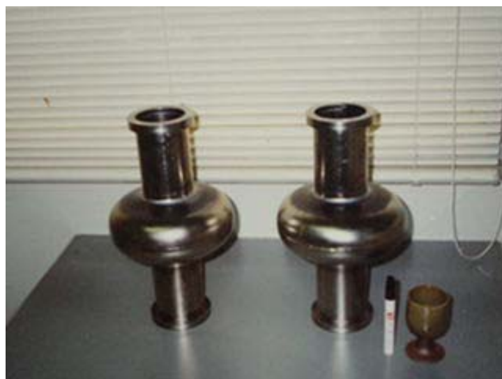
図 5 完成した L バンド単セル空洞
