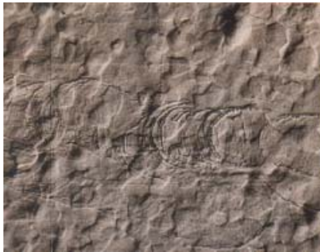
図 5-3 . 横型連続電解研磨でテフロンバッグを付けない場合、ニオブ表面に発生した水素ガスマーク
