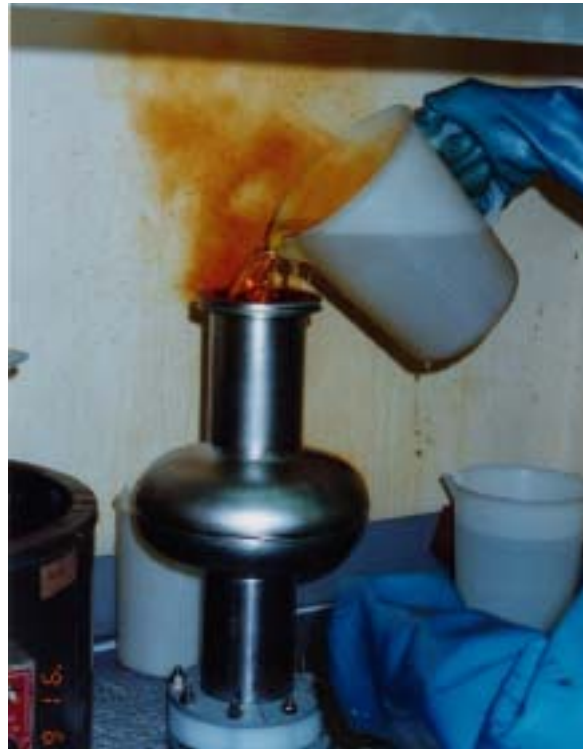
図 1-9 . ニオブ超伝導空洞の化学研磨
