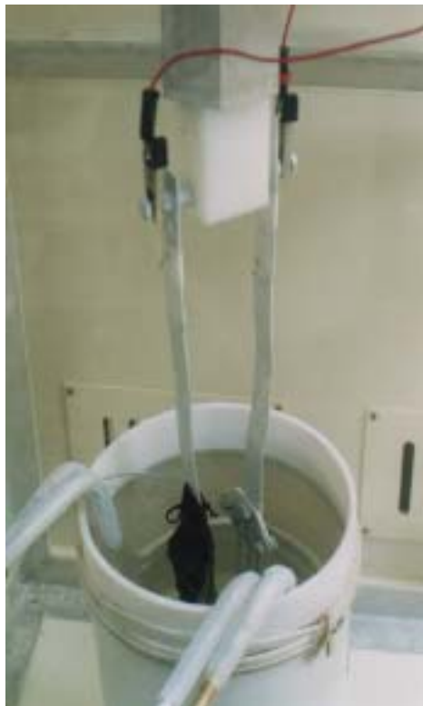
図 5-5. サンプルの電解研磨 (奥がニオブサンプル)
