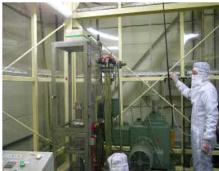
図 1-15 . KEK のクラス 1000 クリーンルーム内に設置された HPR 装置
