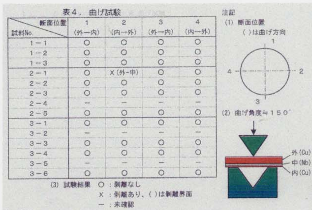
図 8.11 曲げ試験結果
