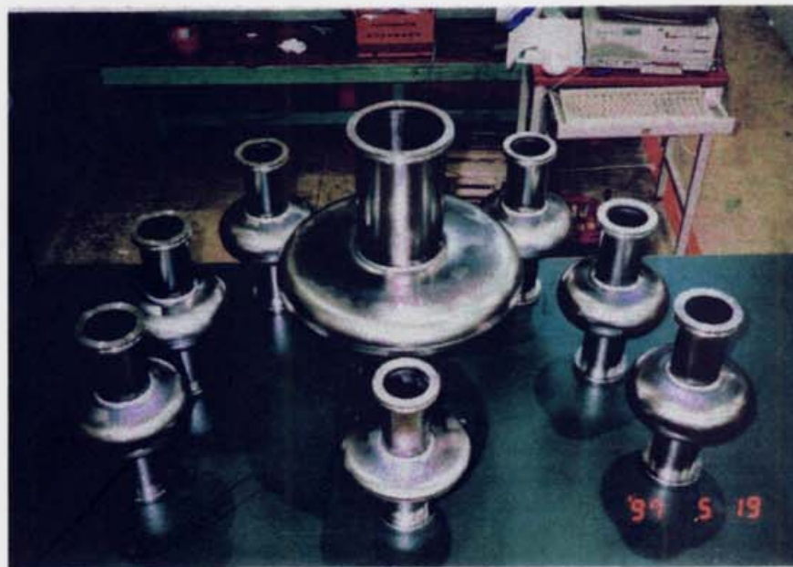
図 6.3 KEK 工作センターが従来法で製作した各種の単空洞
