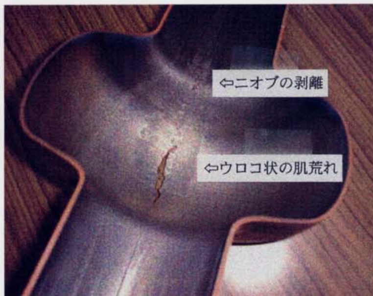
図 10.24 爆着欠陥によるバースト
