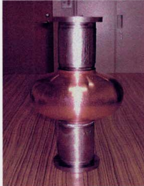
図 7.24 DESY で成型した 1NC4 空洞
