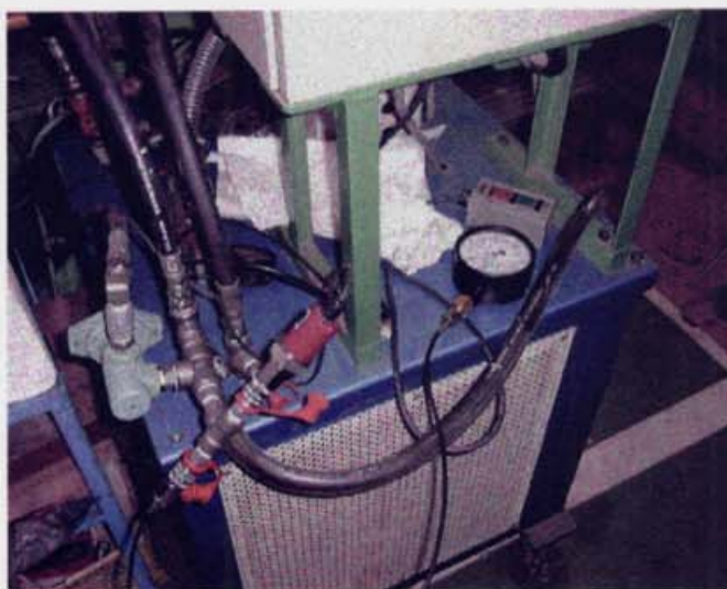
図 10.6 油圧発生装置 (最大圧力 205kg/cmm 2 )
