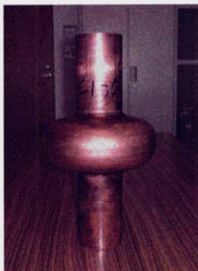
図 10.13 正常に成型された外観（C1-7）
