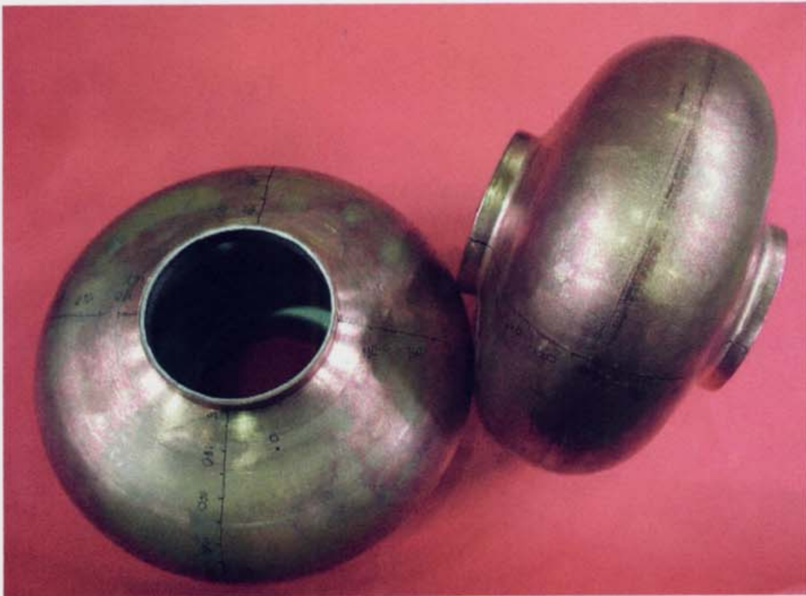
図 7.22 DESY で hidroフォーム法で成型されたクラッド・シームレス空洞
