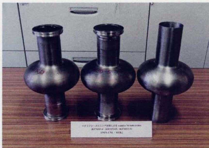
図 6.15 スピニング法で製作した単空洞
