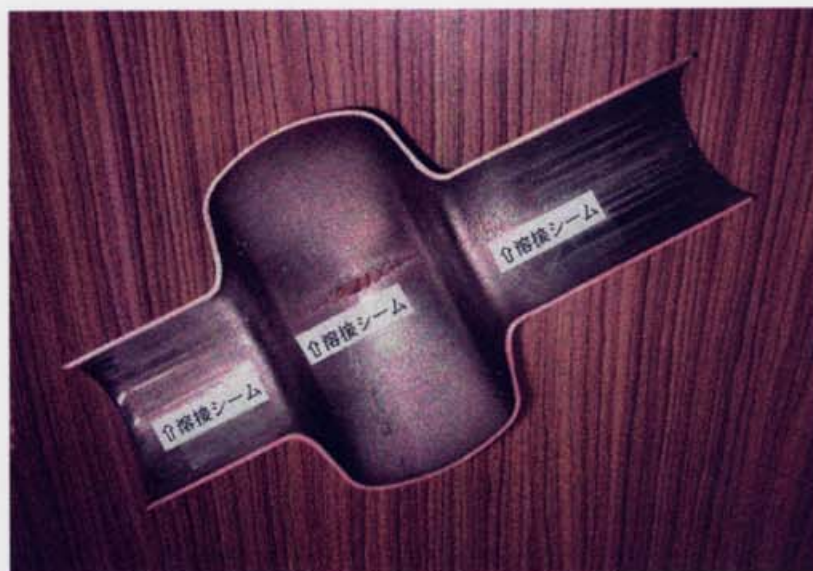
図 10.16 溶接シームに於けるバースト（ENC-1）
