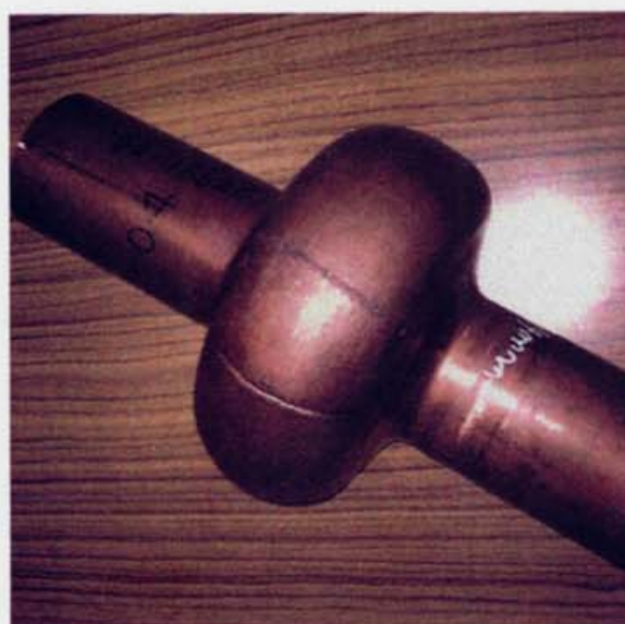
図 10.17 爆着欠陥によるバースト（22981-04）
