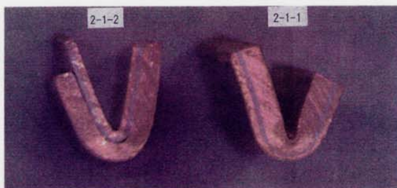
図 8.12 曲げ試験の結果、剥離したサンプル (左) と正常なサンプル (右)
