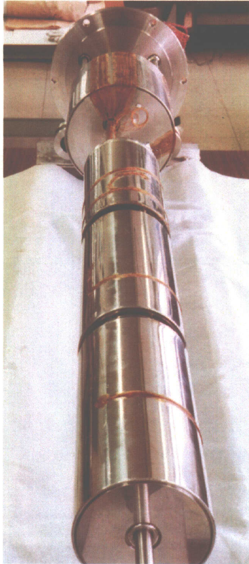
(a) 主タンクと上下の補償タンク
