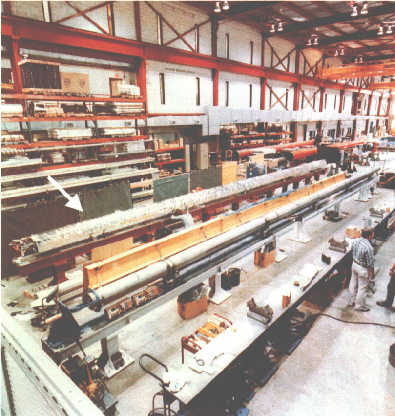
(a) SSC 用ダイポールマグネットの MLI 施工 1986 年 (フェルミ国立加速器研究所 Technical Support Section の Industrial Center Building にて)
