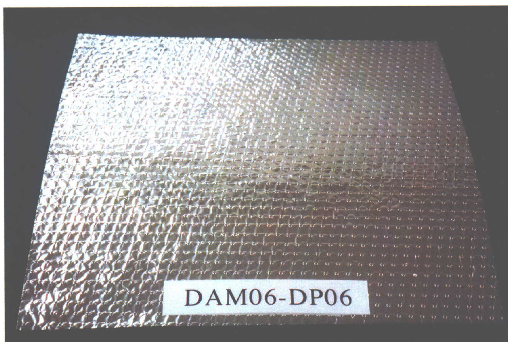
図・付3-8. 厚さ 6\mu\text{m} のポリエステルフィルムを使用した軽量型 MLI (6mm ピッチ傾斜パターン、DAM06-DP06-2)
