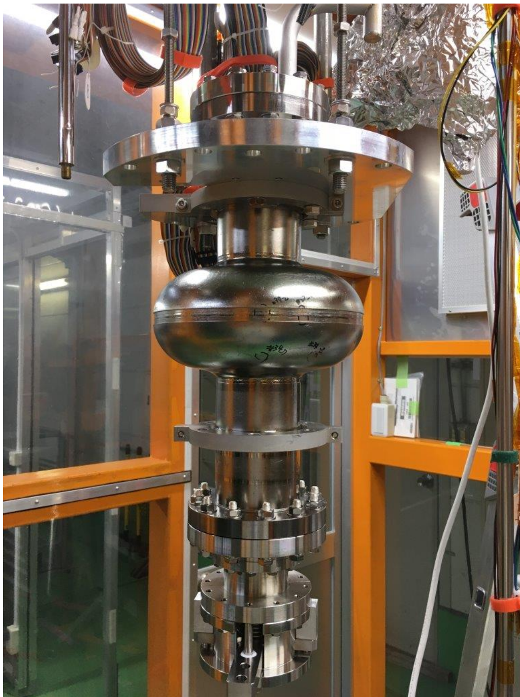
図 7.2 測定に使用したシングルセル超伝導空洞の吊り下げの様子。
