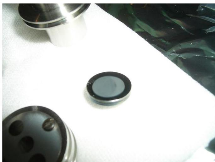
図 3.14: カソード表面分析用 Cs-Te カソード
