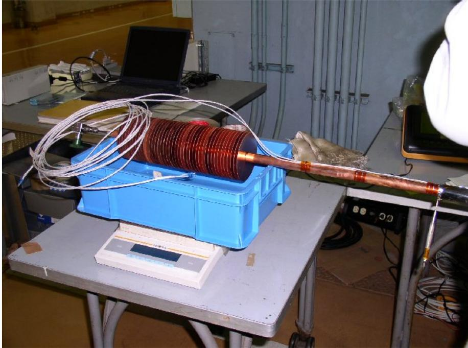
図 B.25: ヒートパイプ試験体
