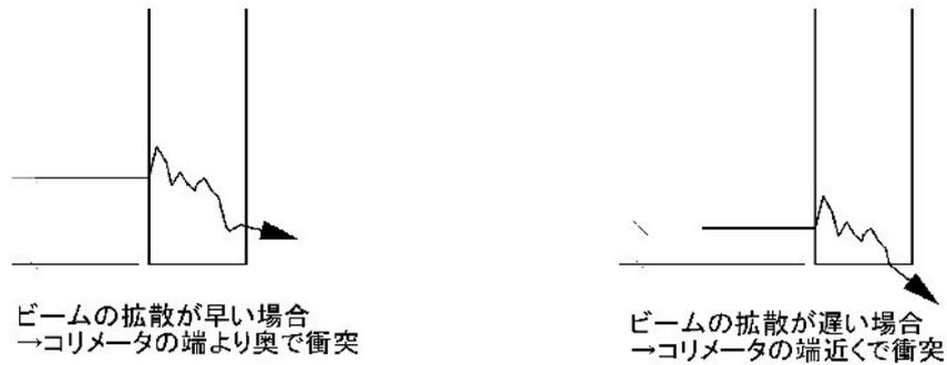
図 3.2: Halo の拡散速度と衝突位置
