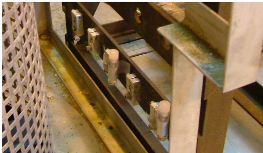
図 B.8: アラニン線量計取付図
