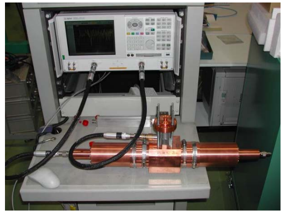
図 55 ニオブモデルの測定の様子（同軸管測定）
