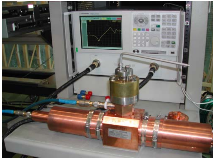
図 33 ブロードバンド特性の測定の様子（同軸管測定装置と HOM カプラ（チューニング冶具を含む））
