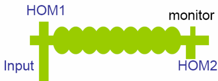
図 66 HOM カプラチューニング時の RF ポートの構成
