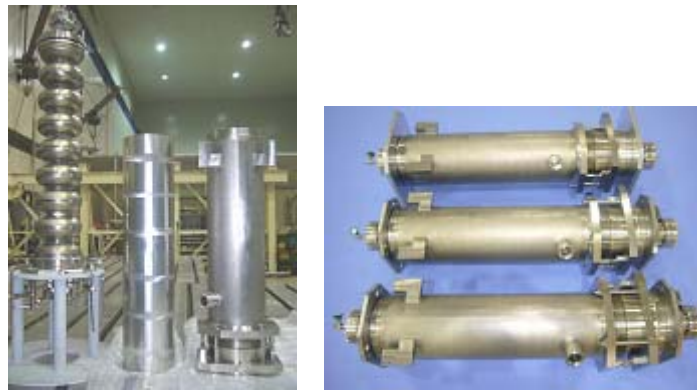
図 8 STF Baseline 空洞と磁気シールドとヘリウムジャケットと溶接された 3 空洞
