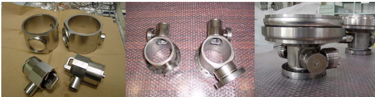
(a) HOM カプラとビームパイプ (b) ビームパイプへ溶接した後 (c) エンドグループ
