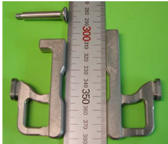
図 53 ニオブ製 HOM カプラの内導体とピックアッププローブ
