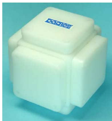
図 13-5 宇宙放射線の方向依存性を測定するための ExpPADLES 線量計。
