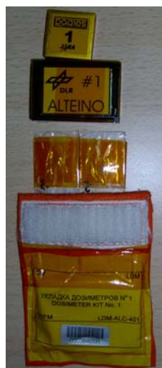
図 12-21 アルトクリス遮へい効果実験に搭載された線量計。上:PADLES 線量計、中央:ドイツ航空宇宙研究所線量計、下:ナポリ大学線量計。
