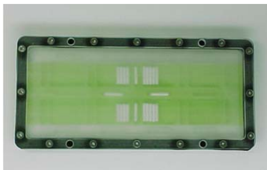
図 9-8 重イオン・ビーム照射用ドシメータ・パッケージの実物写真。
