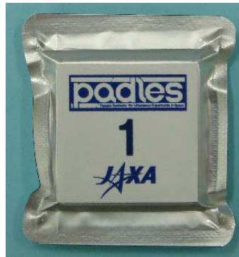
図 7-2 アルミ・ヒートシール・バックに空気とともに封入された PADLES パッケージ(約 3.5cm 角)。
