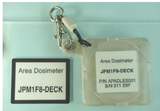
図 13-1 AreaPADLES 線量計の日本実験モジュール「きぼう」船壁への設置イメージ。左:デカール。右:AreaPADLES 線量計。
