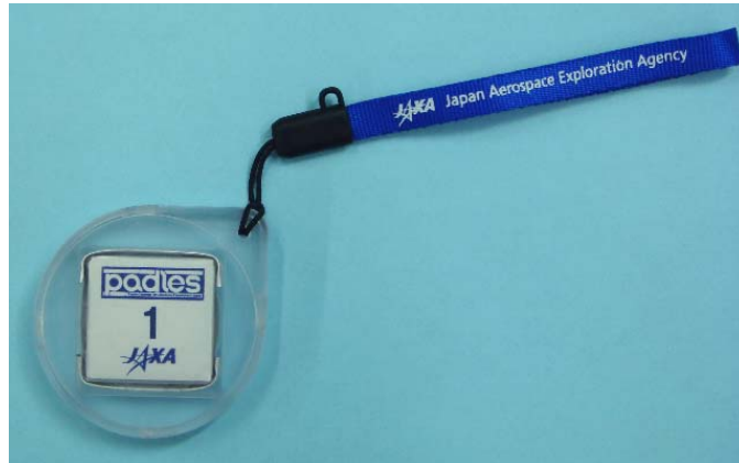
図 13-4 CrewPADLES 線量計。PADLES パッケージをストラップ付きポリカーボネート製のケースに納め、軌道上で宇宙飛行士が携帯しやすい形状になっている。
