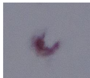
図 4.6 (a)プローブ先端部通過後の半導体レーザーをプローブ取り付け側と反対側のバイアス絶縁環ポートから観察した跡. (b) 探針部通過直後における感光紙による Nd:YAG レーザーの跡. (a), (b)共に探針部による影が確認できる.
