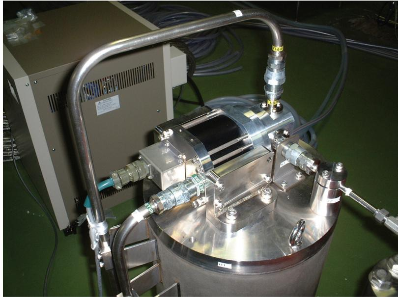
Fig. 5-8 バルブユニットおよびバルブ台
