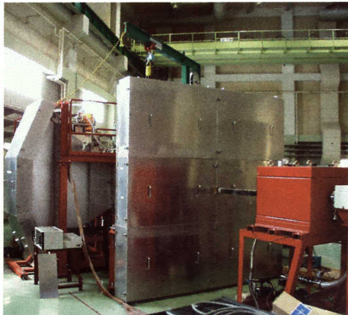
图 3 - 3 - 2 超高分解能粉末中子回折装置 Sirius
