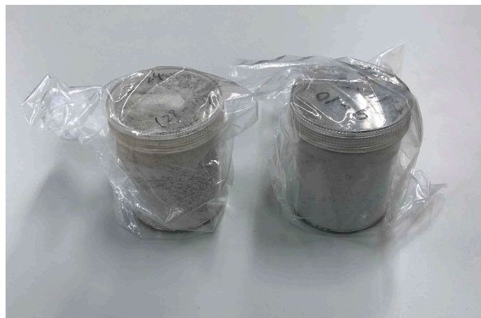
Fig. 5.19: 普通コンクリート及び低放射化コンクリートの粉砕サンプルの写真
