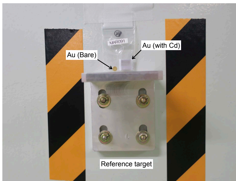
Fig. 5.5: 金箔設置方法
