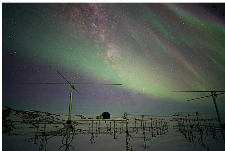
南極昭和基地の大型大気レーダー「PANSYレーダー」のアンテナ群
