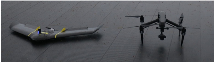
図 3-7 本研究で使用した無人航空機。左が SenseFly 社“eBee Plus”、右が DJI 社“Inspire 2”。
