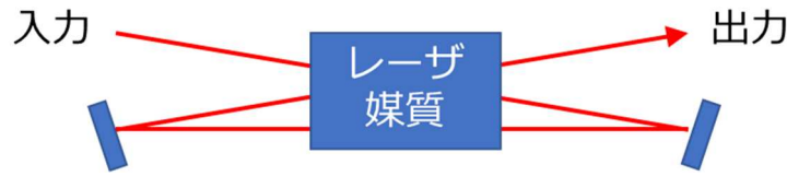
図 2-7. マルチパス増幅器の模式図(3 パス)
