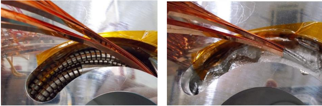
(g) 流し込む前と、流し込んだ直後の様子。右図は低融点金属が固化した状態である。
