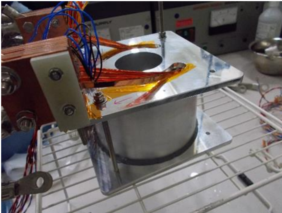
(h) WISE ソレノイド ( I ) の製作完了時の外観
