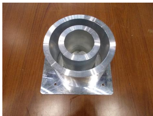
(b) 巻き枠。2本の単管と底板より構成される。底板とそれぞれの単管の接続は、エポキシ樹脂を用いて隙間なく接着した。
