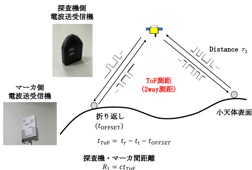
図 4.3: ToF 測距の原理
